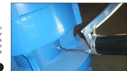
Para lubricar los cojinetes de los rodillos, primero deben desmontarse del dispositivo. Para ello:
