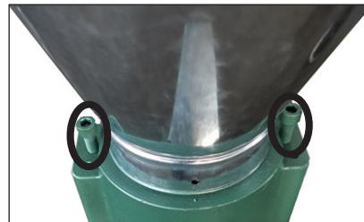
**VIGYÁZATI!** A csavarokat egyformán kell meghúzní. Ellenkező esetben az egyik görgő nem fog forogni. Húzza meg a csavarokat óvatosan és egyenletesen. Ha túlságosan meghúzza őket, az egyik görgő megakadhat és/vagy a tengely eldeformálódhat. Ne növelje a hengernyomást a csavarok meghúzásával, ha a szerszám eltömődött.
