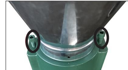
**ATTENTION !** : Les vis doivent être serrées de la même façon. Sinon, un des rouleaux ne tournera pas. Serrez les vis soigneusement et uniformément. Si elles sont trop serrées, l'un des rouleaux peut caler et/ou l'arbre de transmission peut se déformer. De plus, la pression du rouleau ne doit pas être augmentée en serrant les vis lorsque la matrice est bouchée.
