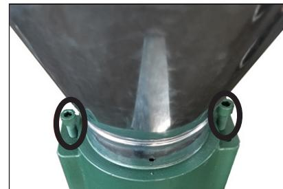
**ACHTUNG!**: Ziehen Sie die Schrauben vorsichtig und gleichmäßig an. Sind sie zu fest angezogen, gerät unter Umständen eine der Rollen ins Stocken und / oder die Welle verformt sich. Außerdem darf der Walzendruck nicht durch Anziehen der Schrauben erhöht werden, wenn die Matrize verstopt ist.
