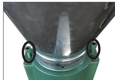
**VIGYÁZAT!** A csavarokat egyformán kell meghúzni. Ellenkező esetben az egyik görgő nem fog forogni. Húzza meg a csavarokat óvatosan és egyenletesen. Ha túlságosan meghúzza őket, az egyik görgő megakadhat és/vagy a tengely eldeformálódhat. Ne növelje a hengernyomást a csavarok meghúzásával, ha a szerszám eltömödött.
