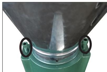
**NOTA:** Los tornillos deben estar igualmente apretados. De lo contrario, uno de los rodillos no girará. Apriete los tornillos con cuidado y uniformemente. Si se aprieta demasiado, hay peligro de que los rodillos se atasquen y/o el eje se deforme. Además, no se debe aumentar la presión de los rodillos apretando los tornillos cuando el troquel está obstruido.
