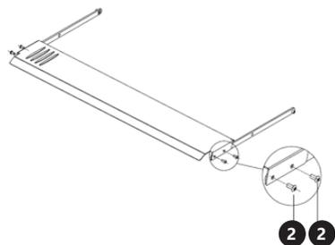
II. Fixez les deux panneaux latéraux au conteneur principal à l'aide des vis M4 [2].
