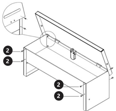
III. Pomocí nylonových matic připevněte po obou stranách nášlapnou plochu. Příliš nedotahujte.
