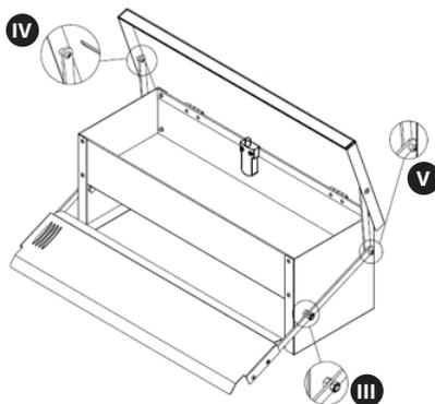
Hinweis! Um den Vögeln zu helfen, sich an den Futterautomat zu gewöhnen und zu lernen, wie er funktioniert, wird es empfohlen, die Schrauben vom oberen zum unteren Loch festzuziehen.
