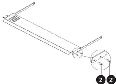
II. Pomocí šroubů M4 [2] připevněte dva boční panely k hlavní nádobě.
