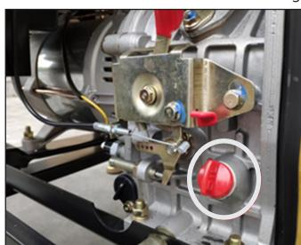
Ein kompletter Ölwechsel wird empfohlen:
