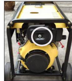
**ATENCIÓN: ¡No arranque la máquina sin filtro de aire!**
