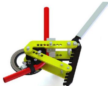
Achtung: Beim Biegen eines Rohrs über 120 ° kann ein Rohr in der Maschine stecken bleiben. Um das Rohr zu lösen, entfernen Sie zuerst den Stift, der den Gurt blockiert, und klopfen Sie dann vorsichtig auf das Rohr. Dies erleichtert das Entfernen.
