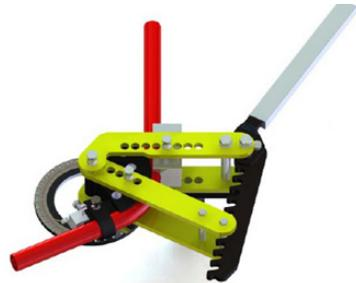
Poznámka: Při ohýbání trubky nad 120 ° se může trubka v zařízení zaseknout. Pro její uvolnění nejprve odstraňte čep blokující popruh a potom jemně poklepejte na trubku. To usnadní odstraňování.
