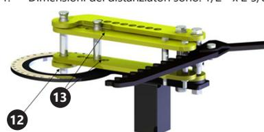
12. Rimuovere il perno 1", inserire il telaio del braccio girevole nel telaio principale, allineare i fori e inserire il perno 1" come indicato nel disegno.
