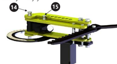
14. Wyciągnąć pin 1" i pin 7/8", w ramie ramienia obrotowego umieścić matrycę, wsunąć pin 1" w otwory ram oraz rękaw matrycy.
