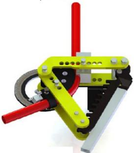
3. Usunąć pin 7/8". Obrócić ramię obrotowe w kierunku przeciwnym do ruchu wskazówek zegara (uważając by nie poruszyć rury). Włożyć pin 7/8" i powtórzyć proces gięcia do uzyskanie pożądanego kąta.
