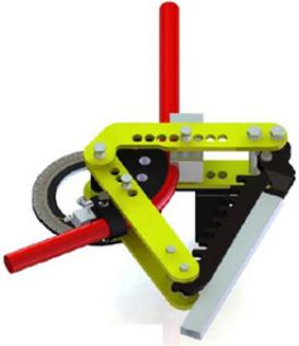
3. Rimuovere il perno 7/8". Ruotare il braccio girevole in senso antiorario (facendo attenzione a non muovere il tubo). Inserire il perno 7/8" e ripetere il processo di piegatura fino a raggiungere l'angolo desiderato.
