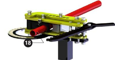
18. Legen Sie den Gurt bzw. Riemen um das Rohr, spannen Sie ihn an und stecken Sie den Stift durch den Riemen und die Matrize.
