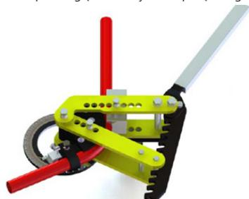
Uwaga: Podczas gięcia rury powyżej 120° może wystąpić zablokowanie rury w urządzeniu. Wówczas by zwolnić rurę należy najpierw wyjąć pin blokujący pasek a następnie uderzyć delikatnie w rurę. Ułatwi to jej wyjęcie.
