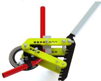
Attention : Lorsque vous cintrez un tuyau au-dessus de 120°, il peut se coincer dans la machine. Alors, pour libérer le tuyau, retirez d'abord la goupille bloquant la courroie, puis appuyez doucement sur le tuyau. Cela facilitera le retrait.
