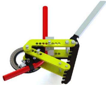
Nota: Durante la piegatura di un tubo al di sopra dei 120°, il tubo potrebbe bloccarsi nell'unità. Per rilasciare il tubo, rimuovere prima il perno di bloccaggio della cinghia e quindi battere delicatamente il tubo. Questo faciliterà la rimozione del tubo.
