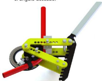
Atención: Al doblar una tubería más de 120°, esta puede bloquearse en el aparato. Entonces, para liberar la tubería, primero saque la clavija de bloqueo de la correa y después golpee delicadamente la tubería. Eso facilitará sacarla.
