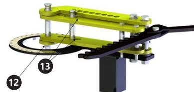
12. Wyjąć pin 1", włożyć ramę ramienia obrotowego w ramę główną, wyrównać otwory i włożyć pin 1" zgodnie z rysunkiem.
