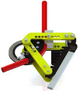
3. Odstraňte čep 7/8". Otočné rameno otočte proti směru hodinových ručiček (dávejte pozor, abyste nepoškodili trubku). Vložte čep 7/8" a opakujte ohýbání, dokud nedosáhnete požadovaného úhlu.
