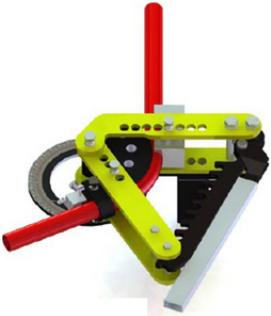
3. Retire la clavija de 7/8". Gire el brazo de rotación en el sentido contrario a las agujas del reloj (con cuidado de no mover la tubería). Introduzca la clavija de 7/8" y repita el proceso de doblado hasta obtener el ángulo deseado.
