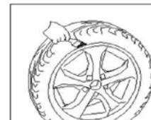
**ATENCIÓN:** No lubricar el talón del aro de la llanta puede ocasionar graves daños al neumático.
