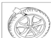
**ATENCIÓN:** Si no lubrica el talón de la llanta, el neumático se puede dañar seriamente.
