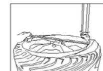
i) Gire el plato en el sentido de las agujas del reloj presionando el pedal (3) hasta que el neumático esté completamente separado del aro de la llanta. Si la operación de desmontaje del neumático se detuviera con un bloqueo o se ralentizara debido a una resistencia fuerte, detenga la rotación del plato (deje de pisar el pedal (3) e invierta temporalmente la rotación del plato levantando el pedal (3). Retire el bloqueo y continúe el desmontaje del neumático.
