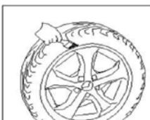
**UWAGA:** Nie nasmarowanie stopki felgi grozi poważnym uszkodzeniem opony.
