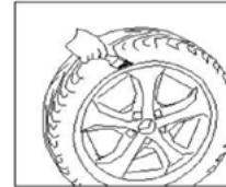
POZOR: Nenamazání patky a ráfku může způsobit vážné poškození pneumatiky.
