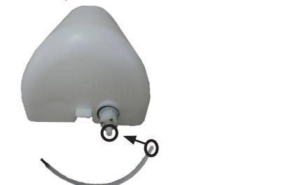
9. Aby zamontować końcówkę roboczą, należy przechylić szorówkę. Założyć końcówkę pracującą na uchwycie trzymającą i obrócić końcówkę pracującą w kierunku odwrotnym do ruchu wskazówek zegara do momentu natkania oporu.
