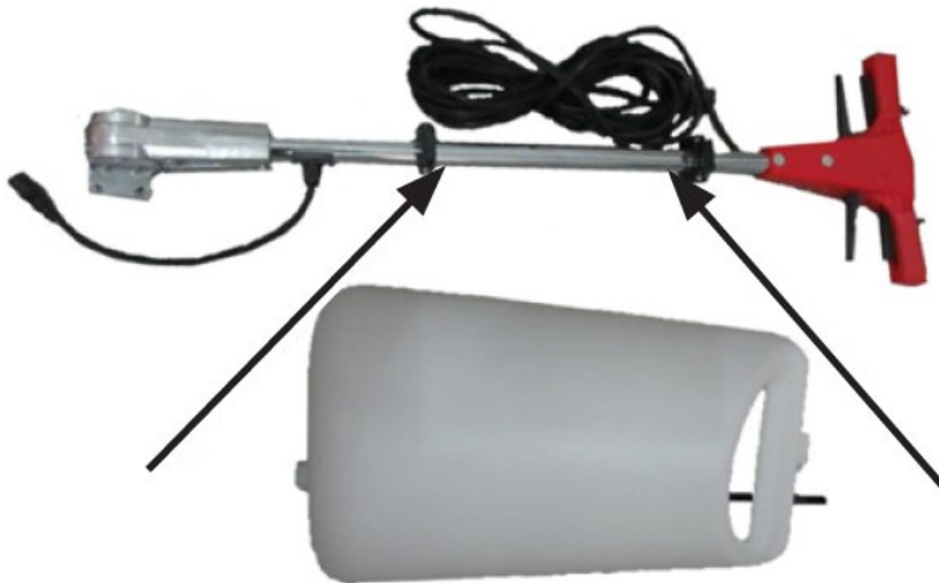
Abbildung 4: Wassertank auf das Rohr der Scheuerscheibe setzen
