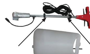
7. Collegare la catena di collegamento della leva di regolazione con il serbatoio.
