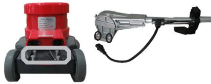
5. Verbinden Sie den am Steuerhebel angebrachten Stecker mit der Buchse unten am Gerät.
