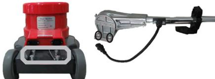
5. Conecte el enchufe del soporte de control al conector ubicado en la parte inferior del dispositivo.
