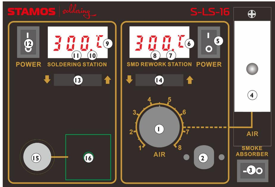
1. Drehknopf zur Regelung vom Luftdurchfluss
