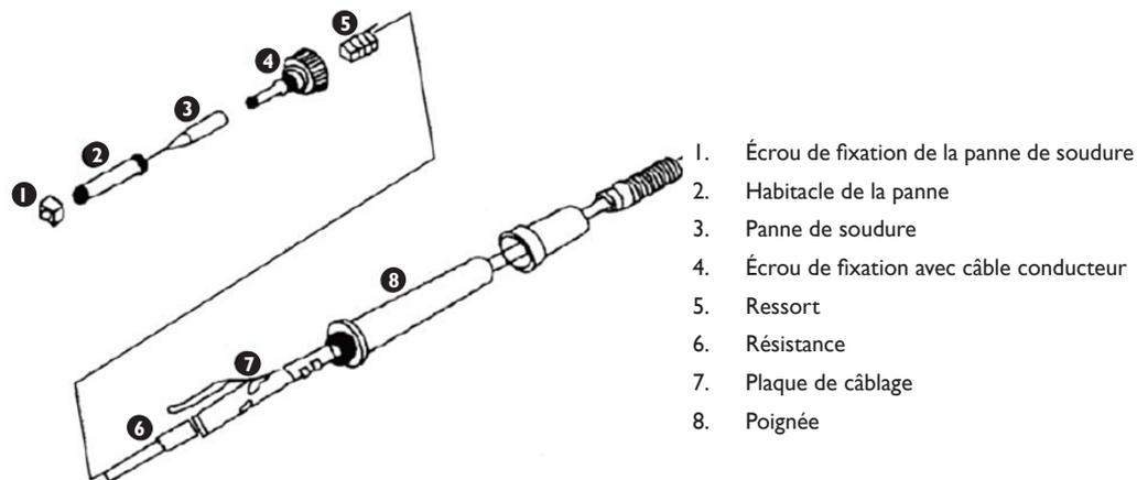
1. Écrou de fixation de la panne de soudure
