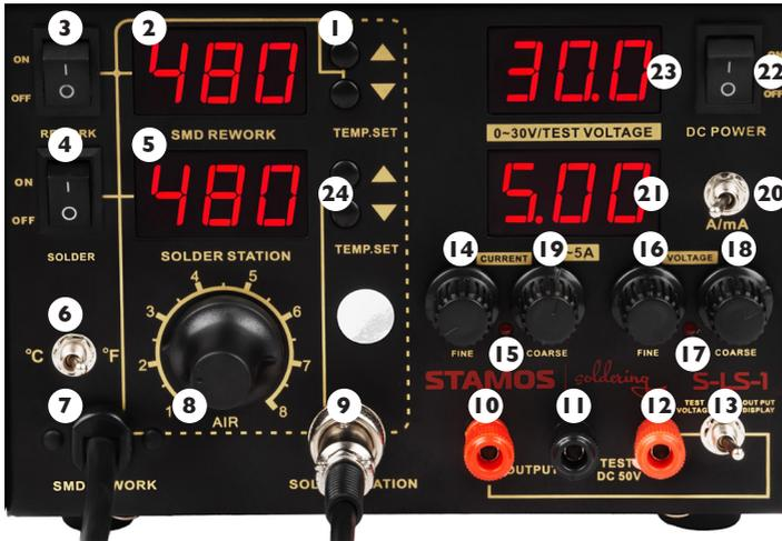
1. Tasten zur Einstellung der Temperatur des Heißluft-Entlöters
