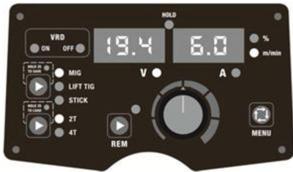
7. ábra. A panel nézete MIG üzemmódban és az előre beállított paraméterekkel.
