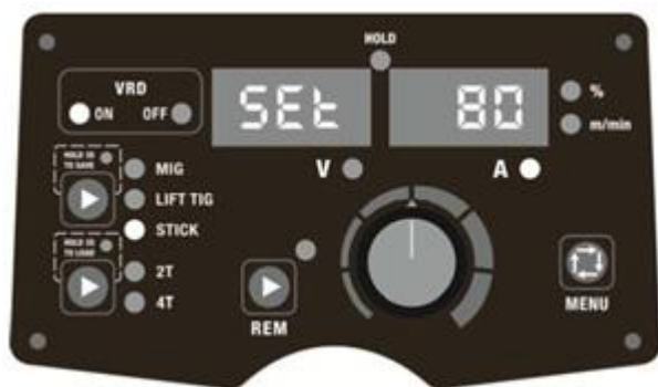
Fig. 1. Funcția VRD activată.
