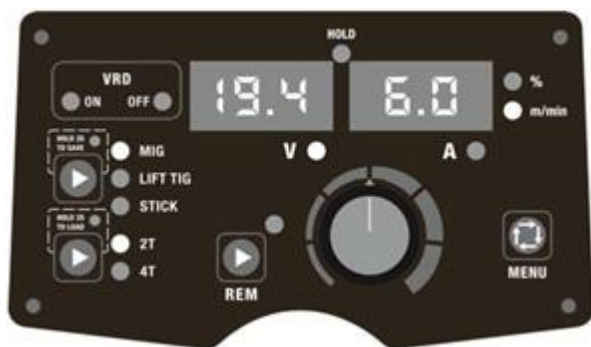
Obr. 7. Pohled na panel v režimu MIG a přednastavené parametry.
