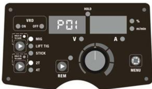
Fig. 15. Gemning af parametre på adressen P01
