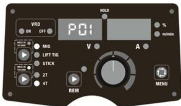
Rys. 16. Wczytywanie parametrów pod adresem P01
