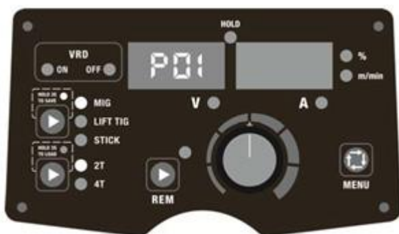
Slika 15. Shranjevanje parametrov na naslovu P01
