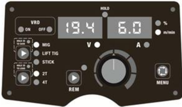
Εικ. 7. Άποψη πίνακα ελέγχου σε λειτουργία MIG και προρυθμισμένες παραμέτρους.
