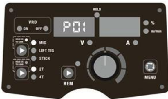
Εικ. 15. Αποθήκευση παραμέτρων στη διεύθυνση P01
