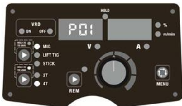
Obr. 16. Načtení parametrů na adrese P01
