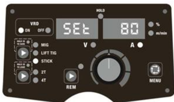
Fig. 1. VRD-funktionen er aktiveret.
