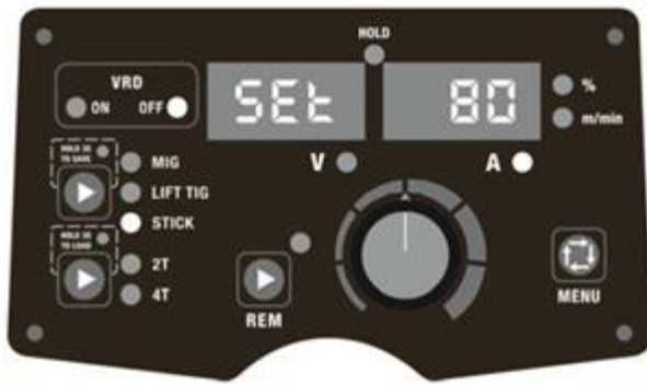
Εικ. 2. Η λειτουργία VRD είναι απενεργοποιημένη.
