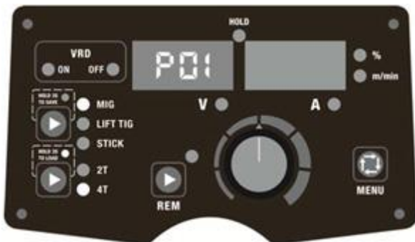
Obr. 16. Načítanie parametrov z adresy P01
