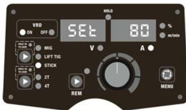
Fig. 1. Função VRD ativada.
