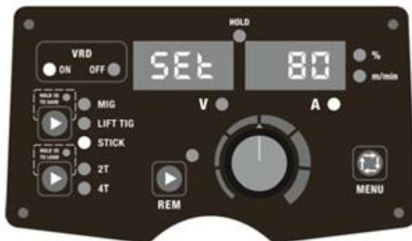
Afb. 1. De VRD-functie is ingeschakeld.
