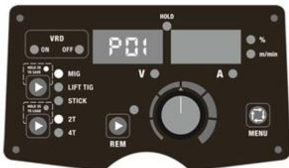
Slika 15. Spremanje parametara na adresu P01
