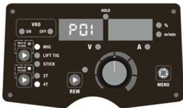
Фиг. 16. Зареждане на параметри на адрес P01
