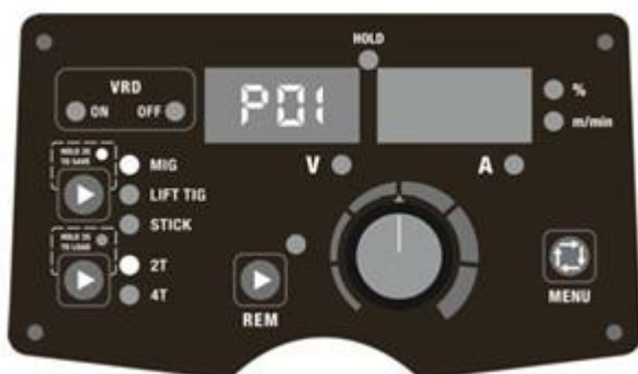
Фиг. 15. Записване на параметри на адрес P01
