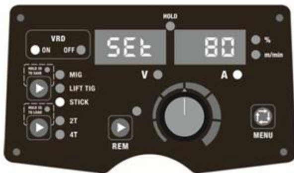
Fig. 1. La fonction VRD est activée.
