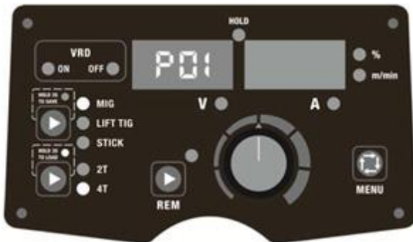
Fig. 16. Loading parameters at P01
