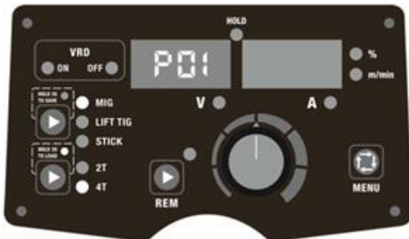
Abb. 16. Laden von Parametern unter P01
