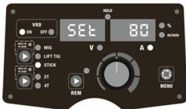
Fig. 1. The VRD function enabled.
