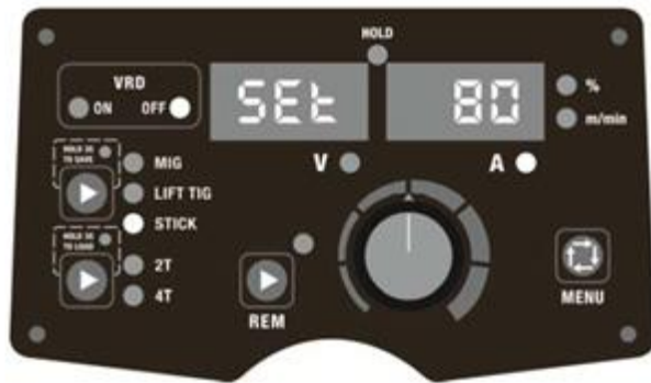
Fig. 2. Funzione VRD disattivata.
