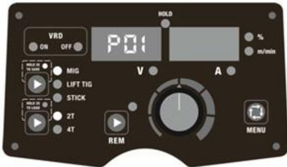
Obr. 15. Ukladanie parametrov na adresu P01
