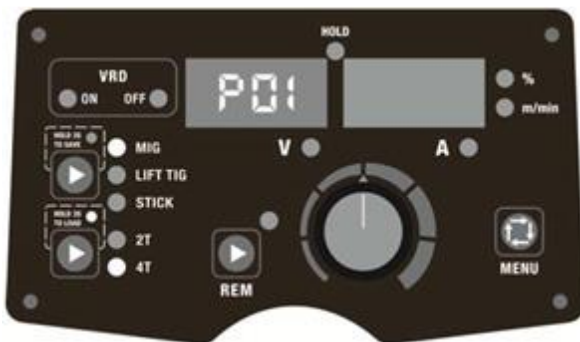
Fig. 16. Caricamento dei parametri all'indirizzo P01
