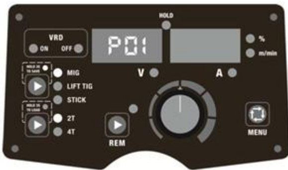
Afb. 15. Parameters opslaan op adres P01
