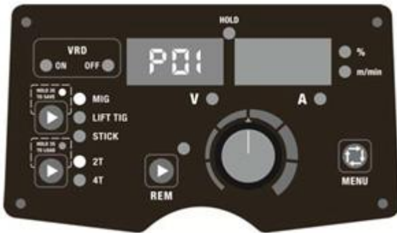
Fig. 15. Guardar parâmetros no endereço P01
