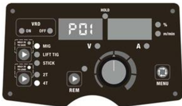
16 pav. Parametrų įkėlimas į adresą P01
