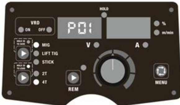
Fig. 16. Laster parametere på P01
