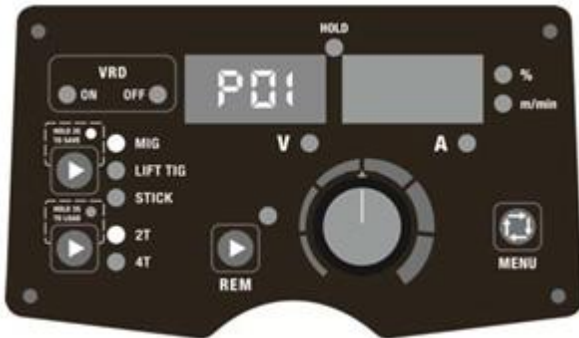
Fig. 15. Lagring av parametere på adresse P01
