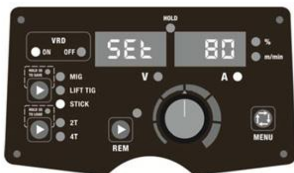
Abb. 1. Die VRD-Funktion ist aktiviert.
