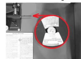
Po założeniu szpuli drutu zamontować górną płytę mocującą, sprężynę oraz pokrętło.
