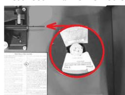
Une fois la bobine montée, remontez la plaque de fixation supérieure, le ressort et le bouton rotatif.
