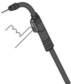
Die Taste am Schweißgriff einschalten (die Endung des Schweißgriffes sollte so weit wie möglich von allen Gegenständen entfernt sein) den Schweißdraht für ca. 5 cm ausziehen.
