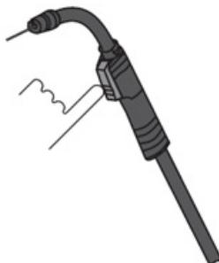
Zapněte tlačítko na svařovacím hořáku (koncovka svařovacího hořáku musí být co nejdále od všech objektů) a vysuňte svařovací drát na vzdálenost asi 5 cm.
