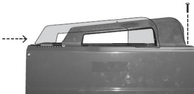
Wsunąć uchwyt w otwory montażowe na pokrywie górnej i zabezpieczyć wkrętem.
