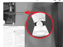
Nach dem Einbau der Drahtspule sind die obere Befestigungsplatte, Feder und Drehknopf zu installieren.
