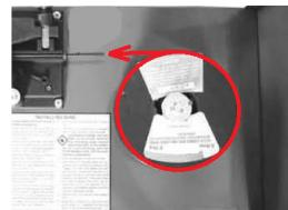
Después de la instalación de la bobina vuelva a colocar la placa de sujeción, el muelle y el botón rotatorio.
