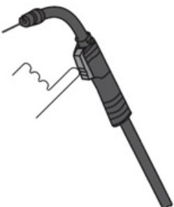
Accendere il tasto sul saldatore (l'estremità del saldatore deve essere il più distante possibile da tutti gli oggetti circostanti) e svolgere il filo di saldatura di circa 5 cm.
