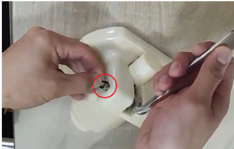
1. Rimuovere l'O-ring dello stelo
