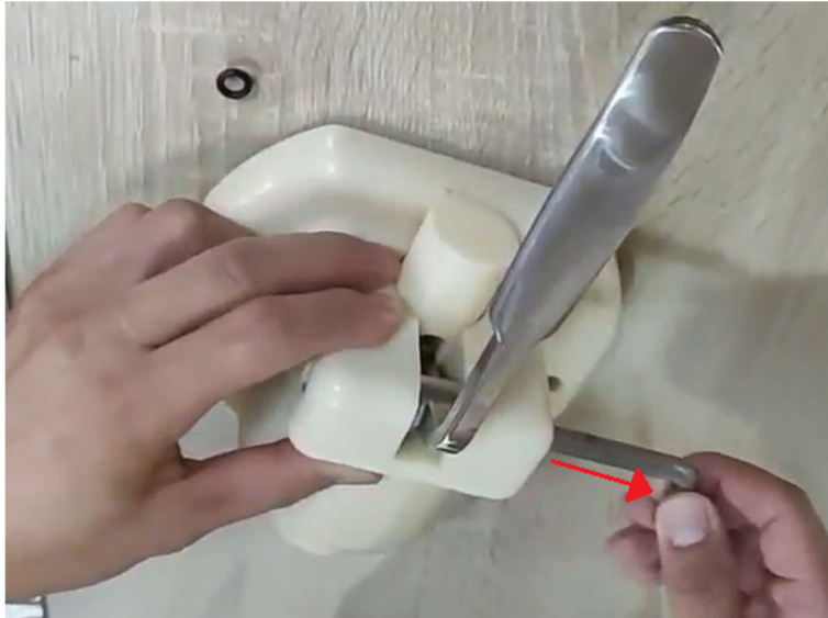
2. Trekk ut splinten
