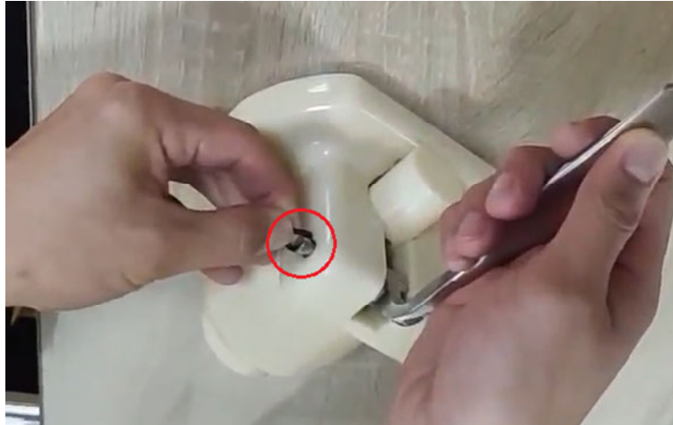
1. Remova o anel de vedação da haste
