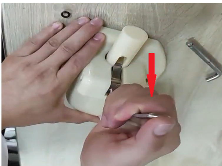
3. Potiahnite páku nadol a vyberte ju
