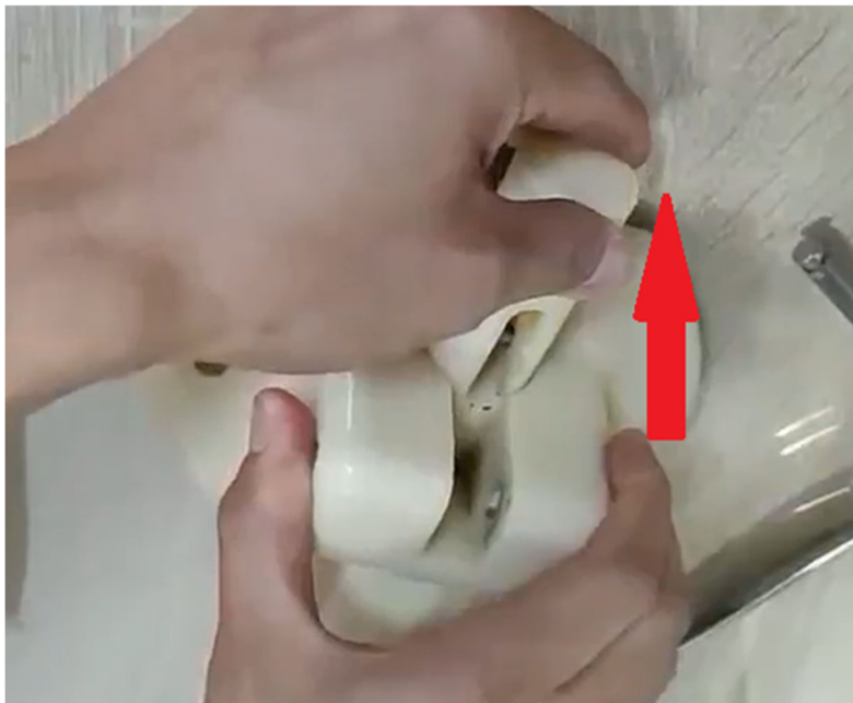
4. Trageți pistonul în sus pentru curățare
