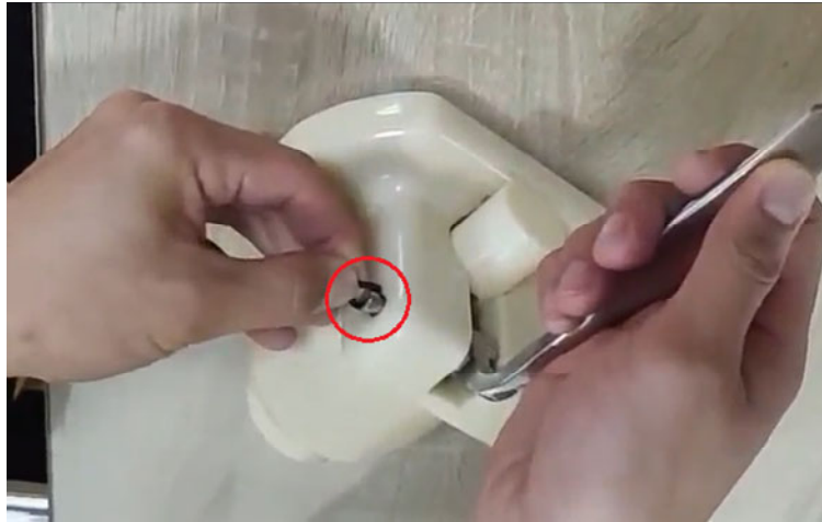
1. Αφαιρέστε τον δακτύλιο O του στελέχους
