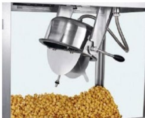
Das zubereitete Popcorn wird aus dem Topf auf den Boden der Auslage geworfen. Diese verfügt über spezielle Löcher, über die die ungepoppten Maiskörner aus dem fertigen Popcorn aussortiert werden, d. h. diese werden in der darunter liegenden Schublade (G) gesammelt. Das Popcorn wird in der Auslage auf der mit dem Drehknopf (F) eingestellten Temperatur gehalten. Falls die Resteschublade voll ist, muss diese geleert und erneut im Gerät eingesetzt werden.
