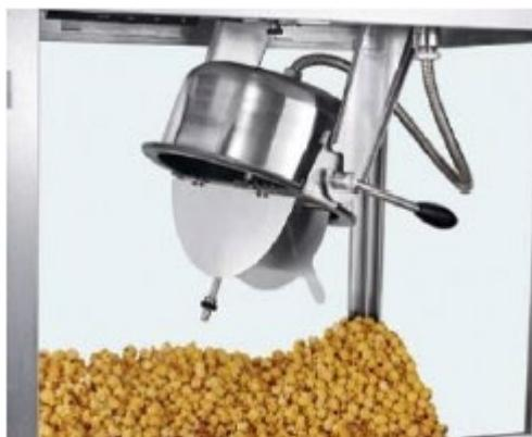
Az elkészített pattogatott kukorica az üstből a vitrin aljára potyog, amin speciális lyukak vannak, így a nem kipattogott kukoricaszemek elválaszthatóak a kész pattogatott kukoricától, ugyanis az alul lévő fiókba (G) esnek. A vitrinben lévő pattogatott kukorica a tekerőgombbal (F) beállított hőmérsékleten van tárolva. Ha a maradékos fiók megtelt, ki kell üríteni és vissza kell helyezni a készülékbe.
