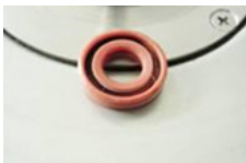
5. Neuen Ring vorbereiten – auf Rückseite drehen
