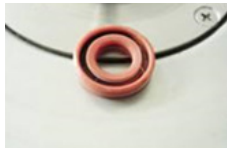
5. Préparer un nouvel anneau – Le déplier conformément
