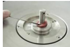
3. Unteren Dichtungsring herausnehmen
