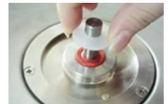
8. Placer le joint supérieur
