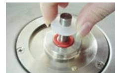
8. Colocar la junta superior
