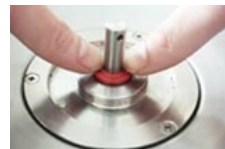
7. Ring auf die Motorachse aufsetzen
