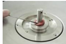
3. Retirar la junta inferior
