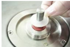
2. Oberen Dichtungsring abnehmen
