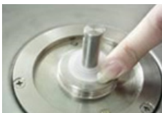
5. Neuen Ring vorbereiten – auf Rückseite drehen
