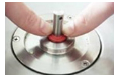
7. Colocar el anillo en el eje del motor
