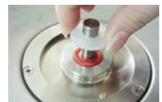
8. Oberen Dichtungsring aufsetzen
