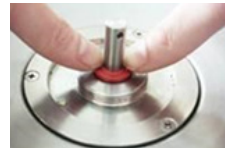
7. Placer l'anneau sur l'axe du moteur
