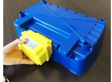
3) De keermotor zo in positie houden en hem, door de reeds voorgevormde gaten, aan de bodem van de broedmachine vastschroeven met de 2 meegeleverde schroeven.
