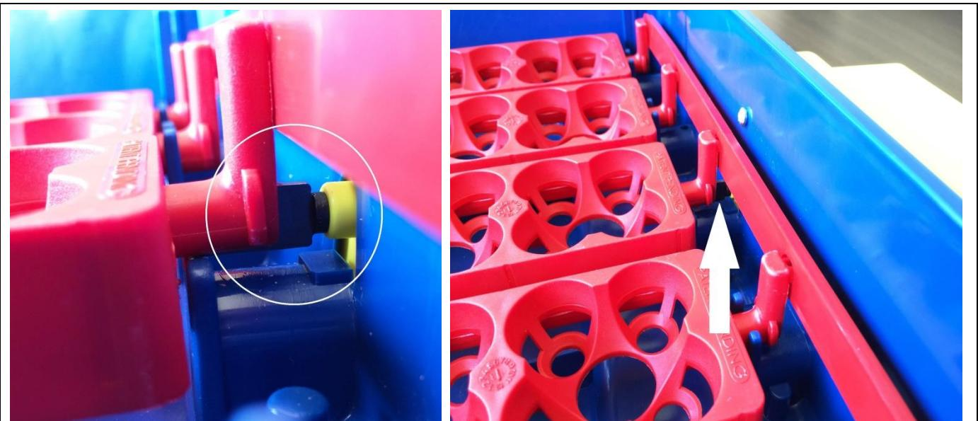
5) Kontrollér, at æggeholderne er placerede korrekt i lejerne og at (for den fuldautomatiske version) **æggemotorens stålflap er helt indsat i slidesen på æggeholderen**, dvs. at plastdelen fra æggeholderen skal sidde over stålflappen.
