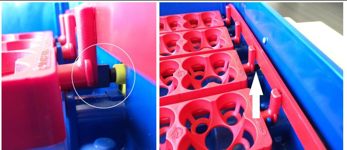
5) Verifieer dat de houders van de eiertray goed in de voor hen bestemde positie zitten en dat **het metalen lipje van de keermotor goed in de gleuf van de eiertray zit, dit wil zeggen dat de houder van de eiertray over het RVS-lipje heen loopt.**
