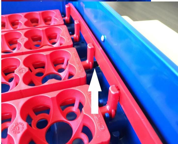
5) Controllare che i supporti porta uova siano posizionati bene nelle sedi e che la **linguetta in acciaio del motore gira uova** sia ben inserita nella fessura del supporto porta uova, cioè la plastica del supporto porta uova deve montare a cavallo della linguetta in acciaio.
