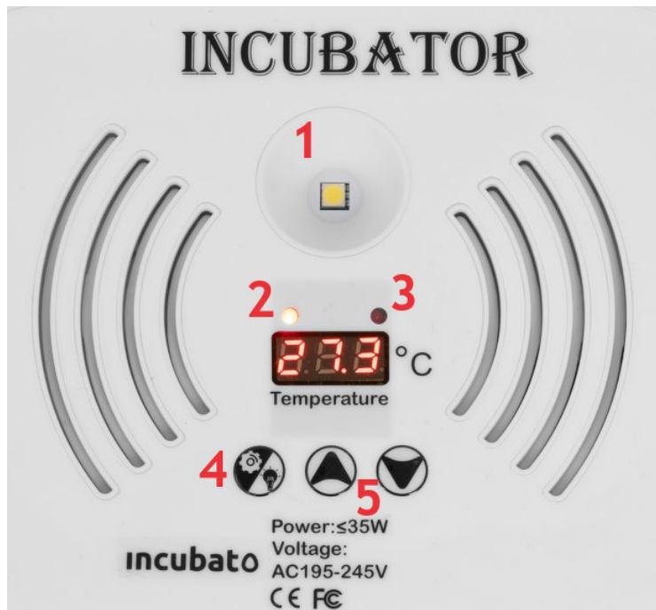
1 – Ovoskop / 2 – Indikatorlampa för drift (uppvärmning) / 3 – Indikeringslampa för parameterinställning / 4 – Temperaturinställningsknapp (tryck en gång) / Ovoskopomkopplare (för att slå på tryck i 3 sekunder. För att stänga av tryck igen, om den inte trycks så släcks lampan efter 6 minuter) / 5 – Knappar för att öka/minska temperaturvärdet. Knapp för att sänka temperaturvärde är också knappen för att testa äggen (långt tryck).
