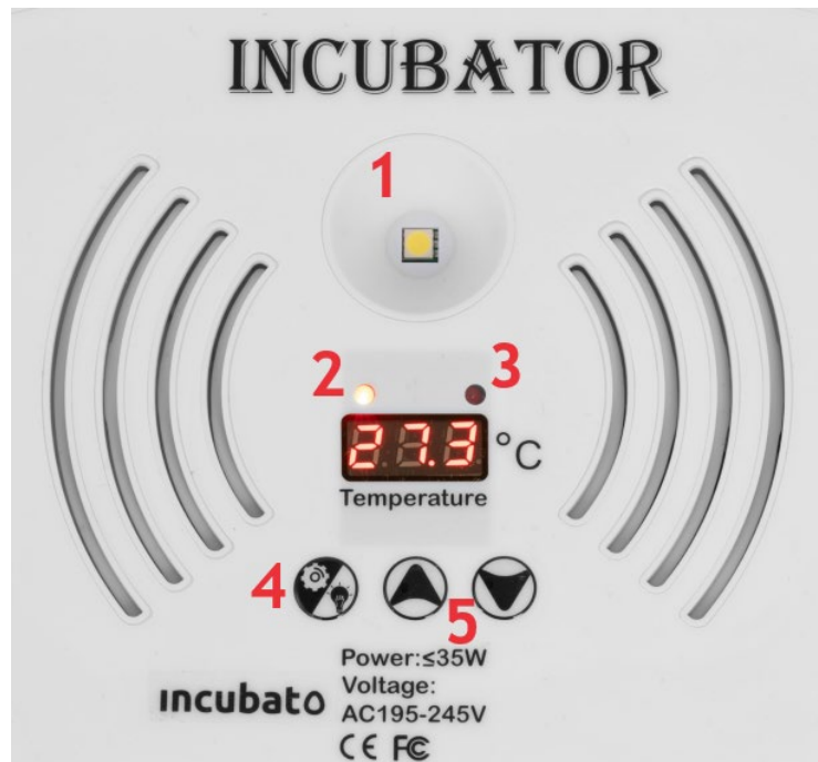
1 - Ovoskop / 2 - Indikatorlampe for drift (opvarmning) / 3 - Indikatorlampe for parameterindstilling / 4 - Temperaturindstillingsknap (tryk én gang) / Ovoskopkontakt (for at tænde tryk i 3 sekunder). Tryk igen for at slukke, hvis der ikke trykkes, slukkes lyset efter 6 minutter) / 5 - Knapper til at øge/sænke temperaturværdien. Knappen til at sænke temperaturværdien er også knappen til at vende testæg (langt tryk).
