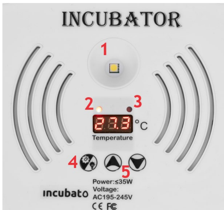
1 - Ovoscope / 2 - Működési (fűtési) jelzőfény / 3 - Paraméterbeállítás jelzőfény / 4 - Hőmérsékletbeállító gomb (egyszer nyomja meg) / Ovoscope kapcsoló (bekapcsoláshoz nyomja meg 3 másodpercig. Kikapcsoláshoz
