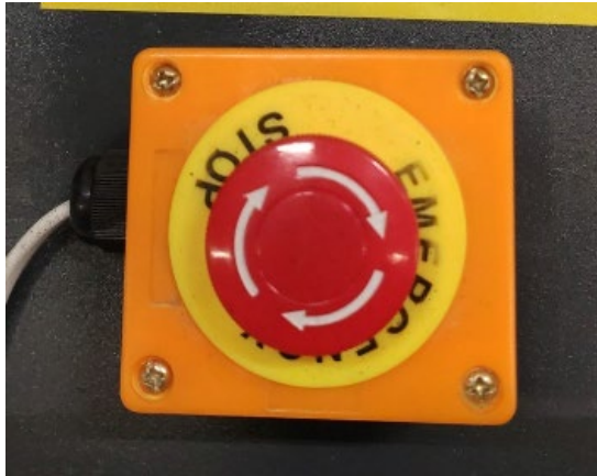
EMERGENCY STOP (roter Pilz) - Not-Aus-Taste der Maschine.
