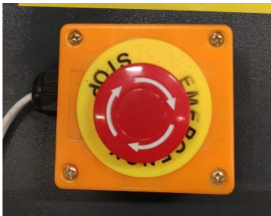
ARRESTO DI EMERGENZA (fungo rosso) - pulsante di arresto di emergenza della macchina.
