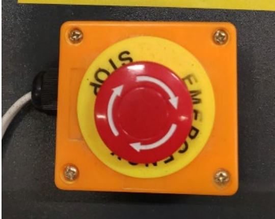
PARADA DE EMERGENCIA (seta roja): botón de parada de emergencia de la máquina.
