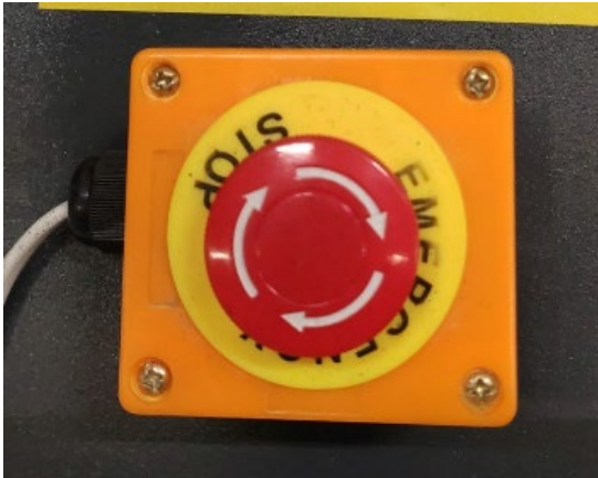
PARADA DE EMERGÊNCIA (cogumelo vermelho) - botão de parada de emergência da máquina.
