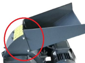
Fixar a calha de entrada da matéria-prima a ser processada
