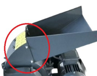
Fest innløpsrennen til råvaren som skal bearbejdes
