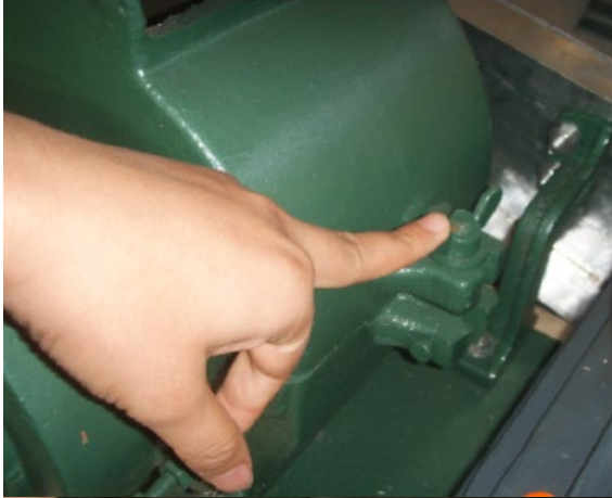
Ouvrir le boîtier du broyeur à marteaux
