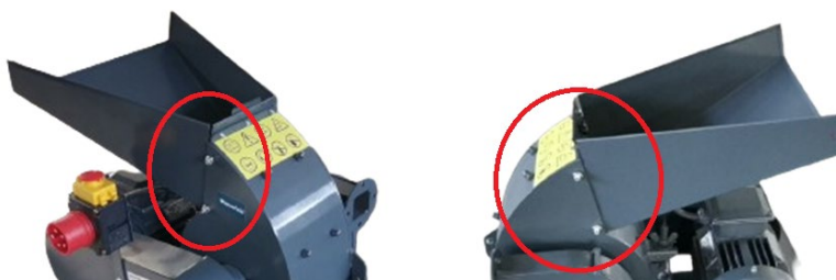
A feldolgozandó nyersanyag bemeneti csúszdájának rögzítése
