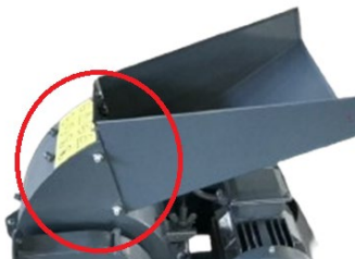
Fijar el conducto de entrada de la materia prima a procesar
