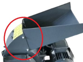
Bevestig de invoergoot van de te verwerken grondstof
