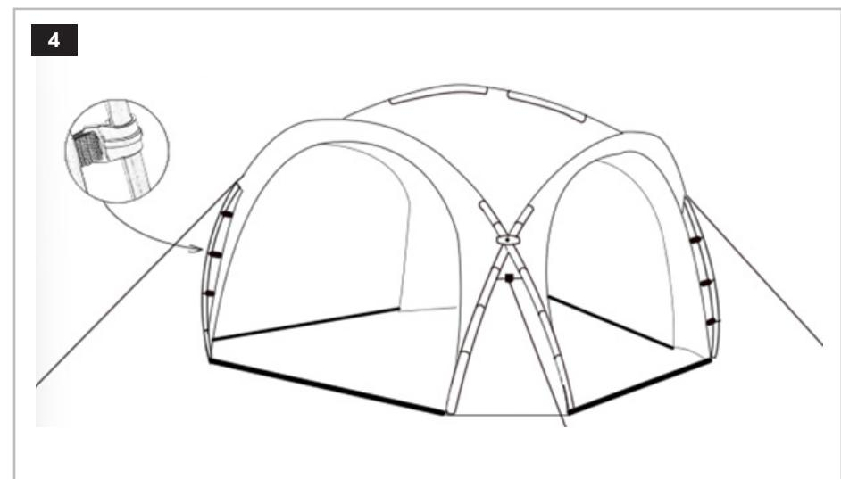
**DA** | Biegen Sie eine lange Stange in die Schnallen 1 und 4, und die langen Pfeile der anderen beiden langen Stangen zeigen in die entsprechenden Schnallen 2 und 3.
