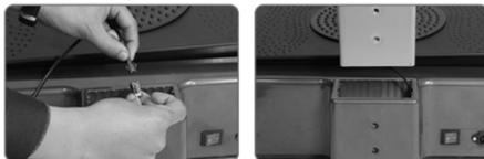
3. Plaats de onderste uiteinden van de handgreep in de gaten aan de rechter- en linkerkant van de basis. Zorg ervoor dat de boutgaten op één lijn liggen, draai de handgrepen vast en draai vervolgens de M6x14-schroeven vast met een inbussleutel.
