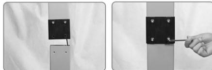
2. Verbind de twee draden en steek vervolgens het onderste uiteinde van de kolom in het rechthoekige gat in de basis. Draai de 2 M6x20-schroeven vast met een inbussleutel.
