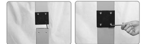
2. Schließen Sie die beiden Kabel an und stecken Sie dann das untere Ende der Säule in die rechteckige Öffnung in der Basis. Ziehen Sie die 2 M6x20-Schrauben mit dem Inbusschlüssel fest.
