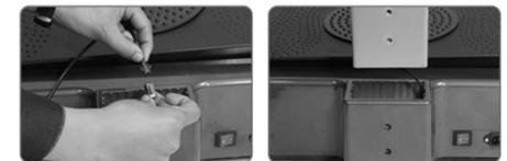
3. Stecken Sie die unteren Enden des Griffs in die Öffnungen auf der rechten und linken Seite der Basis. Stellen Sie sicher, dass die Schraubenbohrungen ausgerichtet sind, drücken Sie die Griffe nach unten und ziehen Sie dann die M6x14-Schrauben mit einem Inbusschlüssel fest.
