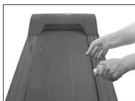
RÉGLAGE DE LA COURROIE DU TAPIS ROULANT
