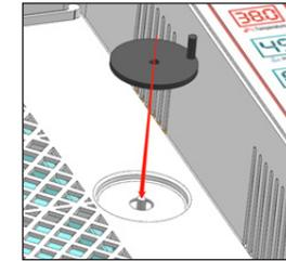
2. Certificar-se de que o elemento saliente do eixo se encaixa no suporte do tabuleiro de ovos.
