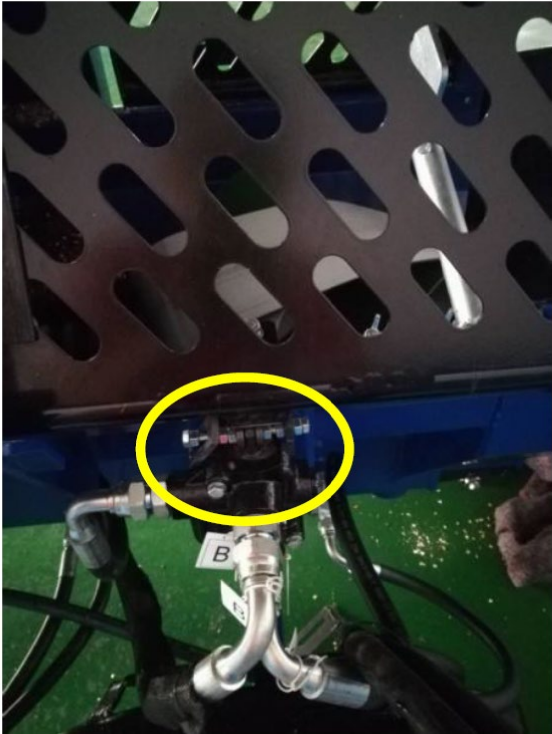
13) Zamontować osłonę klatki na miejscu i dokręcić trzy śruby, jak pokazano poniżej.
