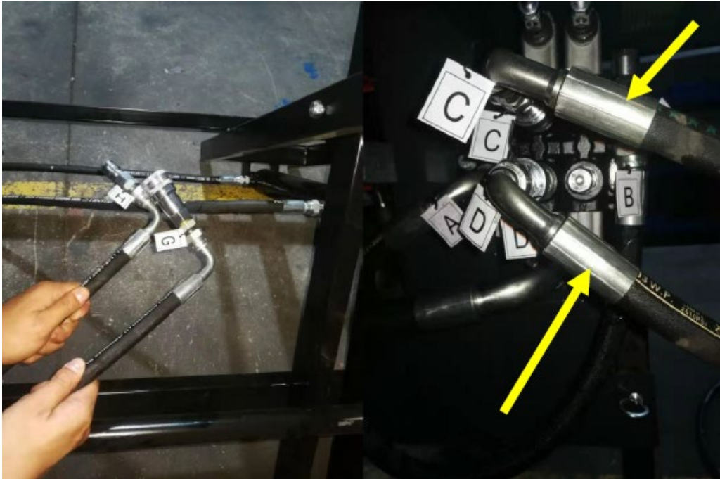
H/G – aansluiting van de cilinder van de houtlift voor de hefmotor.
