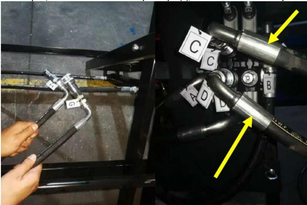
H/G – raccordement du vérin de levage de bûches pour le moteur de levage.
