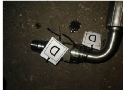
X – conector rapid, Y – intrare hidraulic alimentator (C), Z – iesire alimentator hidraulic (D)
