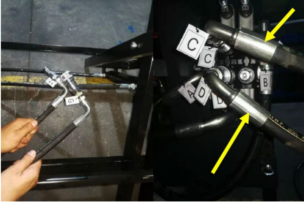
H/G – puunnostimen sylinterin liitäntä nostimen moottorille.
