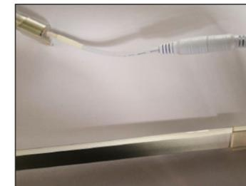
3. Connectez l'extrémité mâle de l'alimentation à l'entrée femelle de la première lampe. En option, si vous souhaitez contrôler les lampes à l'aide d'une télécommande, connectez un module contrôleur entre l'extrémité mâle de l'alimentation et l'extrémité femelle de la lampe.
