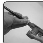
Austausch der Gummidichtung 14mm (O-Ring) | 14mm rubber washer replacement | Wymiana podkładki gumowej 14mm
