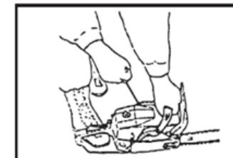
Hinweis: Stellen Sie vor der Inbetriebnahme der Säge sicher, dass die Säge über einen freien Arbeitsbereich verfügt, dass die Antriebseinheit stabil auf dem Boden steht und dass Kette und Führungsschiene den Boden nicht berühren.
