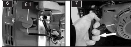
Appoggiarsi contro il motore con una mano (controllare prima che il motore non sia caldo e, in tal caso, lasciarlo raffreddare prima di eseguire questo passaggio), con l'altra mano tirare lentamente il gancio della corda di avviamento finché non si avverte resistenza, quindi scuotere violentemente. Se il motore non si avvia, ripetere la procedura.
