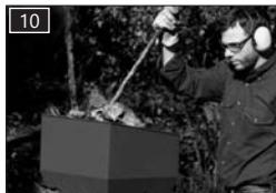
3. Schalten Sie nach Beendigung der Arbeit die Maschine aus, indem Sie den Motorschalter auf OFF stellen. Entfernen Sie das Zündkerzenkabel, bevor Sie das Gerät bewegen, den Beutel leeren, Blockaden entfernen, Flüssigkeiten nachfüllen oder andere Wartungs – oder Reparaturarbeiten durchführen.
