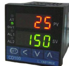
**UWAGA:** Jeżeli ustawiona liczba nie zostanie potwierdzona w ciągu 30 sekund, urządzenie automatycznie powraca do wartości wyjściowej.
