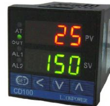
**FIGYELEM:** Amennyiben a beállított szám nem kerül megerősítésre 30 másodpercen belül, a berendezés automatikusan visszaáll a kiindulási értékre.
