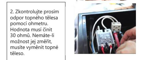
2. Zkontrolujte prosím odpor topného tělesa pomocí ohmetru. Hodnota musí činit 30 ohmů. Nemáte-li možnost jej změřit, musíte vyměnit topné těleso.
