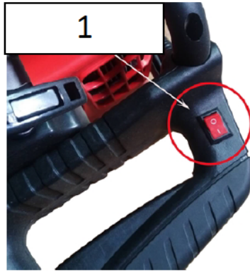
1- Interruptor de extinção de chamas
