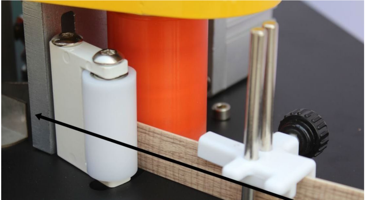
Kantbåndet skal placeres mellem fremføringshjulene og indsættes i knivstyrets rille.
