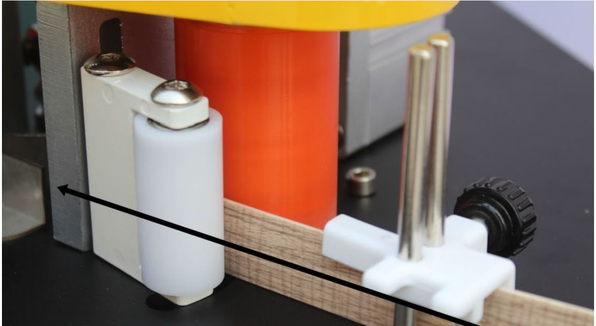
Reunanauha on asetettava syöttöpyörien väliin ja työnnettävä veitsen ohjausuraan.
