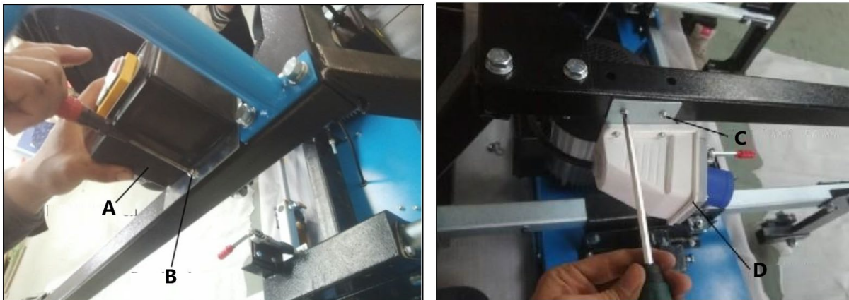
A – Vklonno stikalo B, C – Vijak z okroglo glavo D – Vtič.
