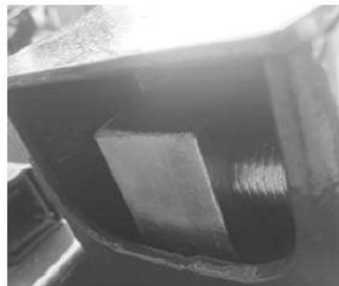
Болт за регулиране на проследяването, разположен във вдлъбнатината. Трябва да
