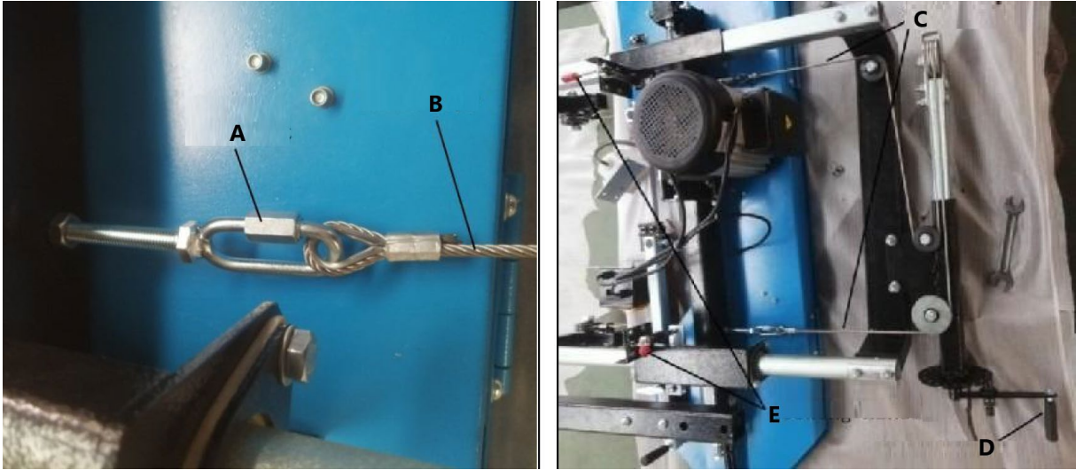
A – Ketjumutteri B – Teräsköysi C – Teräsköysi D – Nostokahva E – Lukituskahva
