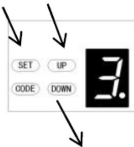
c) Presione el botón **ARRIBA / Abajo** una vez para configurar el tiempo de retardo de apagado del LED (1 ~ 9).
