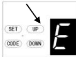
b) Drücken Sie erneut die **SET-Taste**. Das Gerät befindet sich nun im Modus zur Einstellung des Wartungsalarms. Dann erscheint auf dem Display die Zahl "0" mit einem blinkenden Punkt.
