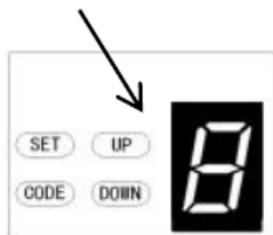
c) Tryck på **UPP/NER** -knappen en gång för att välja om du vill öppna funktionen för delvis öppning eller ställa in höjden för delvis öppning. (0-C). Tryck på **UPP** -knappen för att öka, eller **DOWN** -knappen för att minska.
