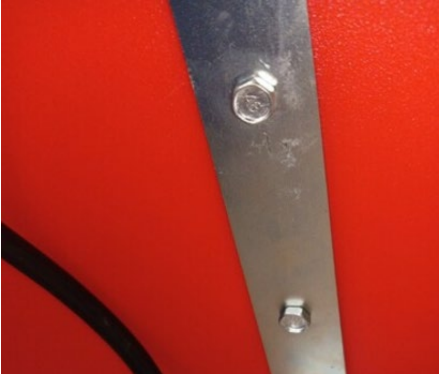
Seuraavaksi ruuvaa letkun ripustin säiliön etukoteloon:
