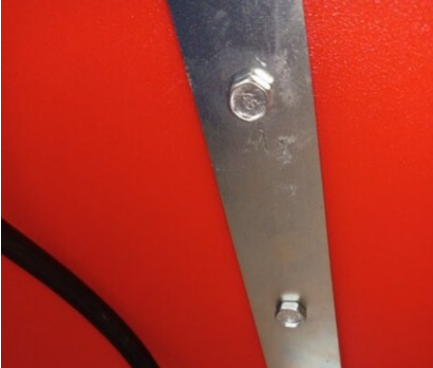
Schroef vervolgens de slanghouder vast aan de voorzijde van de tankbehuizing:
