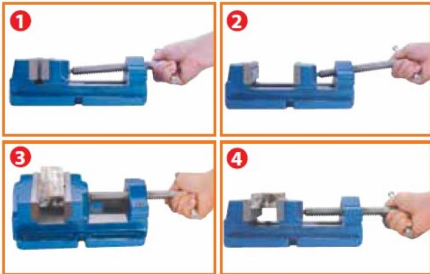
ATTENTION : pour assurer un bon fonctionnement du dispositif, il convient de fixer toujours l'objet traité au centre des mâchoires. Les mâchoires des étaux sont également dotés des fentes permettant la fixation des objets ronds.
