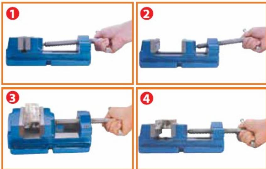
ATTENZIONE: per garantire un funzionamento duraturo e senza problemi, il pezzo da fissare dovrebbe essere sempre posizionato il più vicino possibile al centro delle ganasce. Le morse hanno anche delle scanalature nelle ganasce per assicurare un bloccaggio più efficace degli oggetti rotondi.
