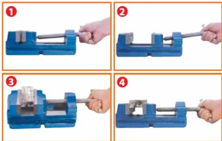
**ACHTUNG:** Für einen langen und störungsfreien Betrieb des Geräts sollte das eingespannte Werkstück immer nach Möglichkeit in der Mitte der Backen positioniert werden. Die Schraubstöcke besitzen auch Rillen in den Backen, um runde Gegenstände sicherer einspannen zu können.
