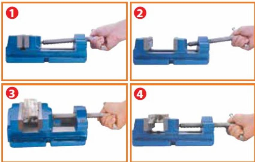
BEMÆRK: for at garantere lang og problemfri drift af udstyret skal det fastspændte emne altid være placeret i midten af bakkerne. Bakker er forsynet med kærve, der garanterer en bedre fastspænding af runde genstande.
