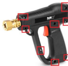
2. Den oberen Teil des Gehäuses abnehmen und das Kabel des Schweißgeräts durch die Pistole führen: ein Kabelende muss an den Abzug geführt werden und das andere an das Kopfteil des Griffes.
