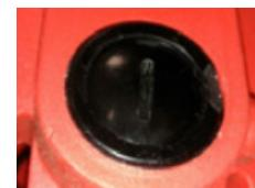
2. Extraiga la escobilla de carbón usada, inserte una nueva escobilla y apriete el tornillo de retención. La escobilla de carbón del otro lado de la carcasa también debe sustituirse.
