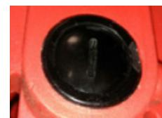
2. Rimuovere la spazzola in carbonio usata, inserire una spazzola nuova e serrare la vite di fissaggio. Anche la spazzola in carbonio sull'altro lato dell'alloggiamento deve essere sostituita.
