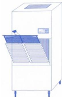
V případě lehkých nečistot odstraňte nahromaděné nečistoty na povrchu sítě čistým hadříkem. V případě silného znečištění také uvnitř sítka filtru opláchněte filtr pod tekoucí vodou a před opětovným vložením do zařízení jej zcela osušte.
