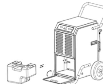
L'icône du réservoir plein peut également être activée en cas d'installation incorrecte - alors son montage doit être corrigé et l'appareil redémarrera automatiquement.
