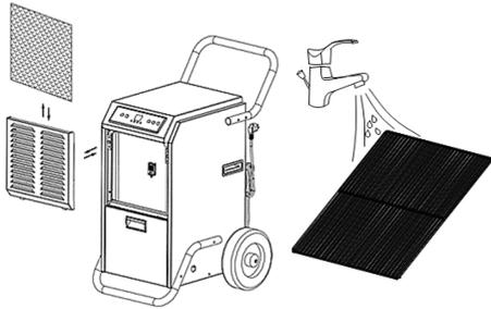
**ATTENZIONE!** non far funzionare il dispositivo senza il filtro dell'aria - potrebbe contaminare l'evaporatore! Non toccare la superficie dell'evaporatore a mani nude – rischio di lesioni!
