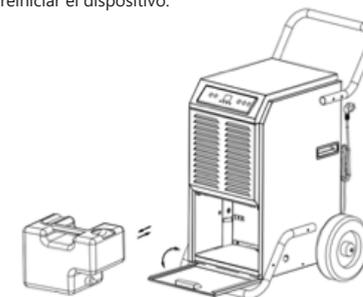
El icono de depósito lleno también puede activarse en caso de su instalación incorrecta; en este caso, se debe rectificar su instalación y el dispositivo se reiniciará automáticamente.
