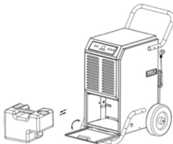
L'icona del serbatoio pieno può anche essere attivata se il serbatoio non è installato correttamente, nel qual caso il serbatoio deve essere riparato e l'apparecchio si riavvia automaticamente.
