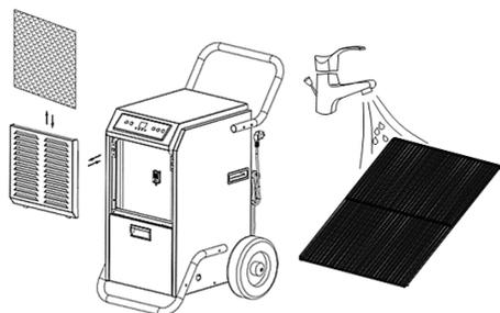
**UWAGA!** Nie wolno używać urządzenia bez filtra powietrza – grozi to zanieczyszczeniem parownika! Nie dotykać powierzchni parownika gołymi dłońmi – ryzyko skaleczenia!
