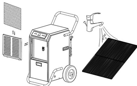
**POZOR!** nepoužívejte zařízení bez vzduchového filtru – mohlo by dojít ke znečištění výparníku! Nedotýkejte se povrchu výparníku holými rukama – nebezpečí poranění!
