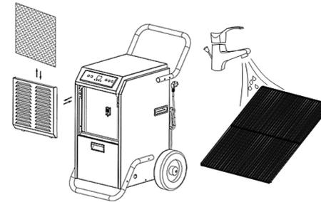
**⚠ ATENCIÓN!** no utilice el dispositivo sin el filtro de aire, podría contaminar el evaporador. No toque la superficie del evaporador con las manos desnudas - riesgo de lesiones.
