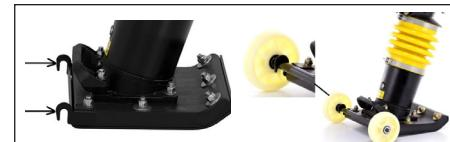
Para instalar las ruedas de transporte de la plataforma, se debe colocar el eje de las ruedas en los ganchos de la plataforma.
