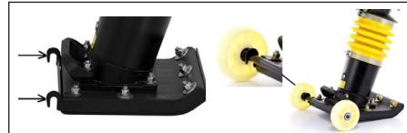
Um die Transportrollen der Plattform zu montieren, befestigen Sie die Achse der Räder an den Haken der Plattform.
