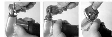
c) Zamontować odkręcone elementy w odwrotnej do demontażu kolejności.
