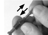
c) Remontez les parties démontées dans le sens inverse du démontage.
