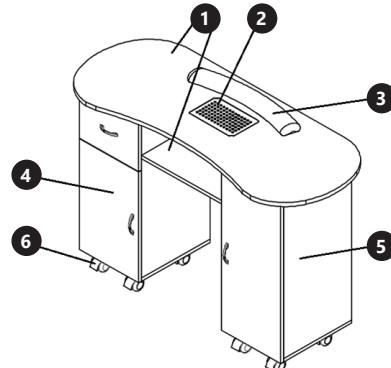
1. Tablero con orificio y estantería para el aspirador de polvo
