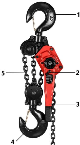
1. Hák pro zavěšení na nosnou konstrukci
