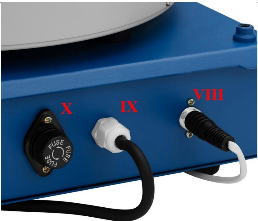
VIII - gniazdo termopary zewnętrznej/wewnętrznej
