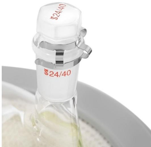
5. Insérez le raccord au vide [4] dans l'un des plus petits cols du ballon [2].
