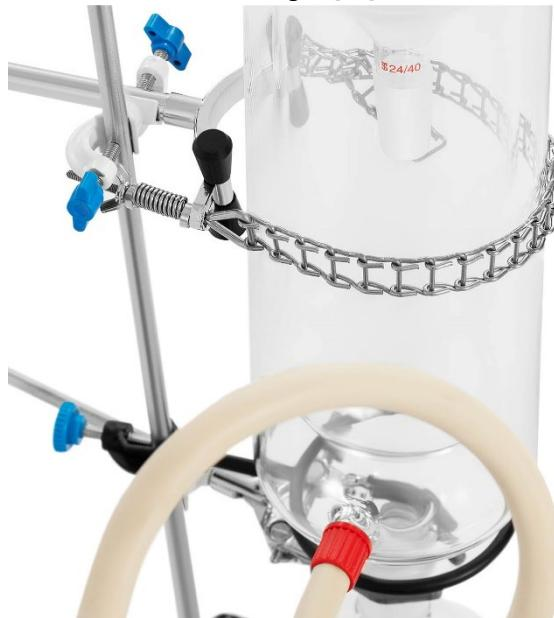
26. Sæt kondensatoren [17] og modtagerkolben (1000 ml) [20] fast med en clips.
