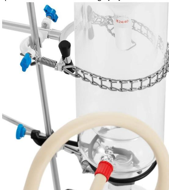
26. Sécurisez le point de connexion du piège à froid [17] et du ballon récepteur (1000 ml) [20] avec une pince.
