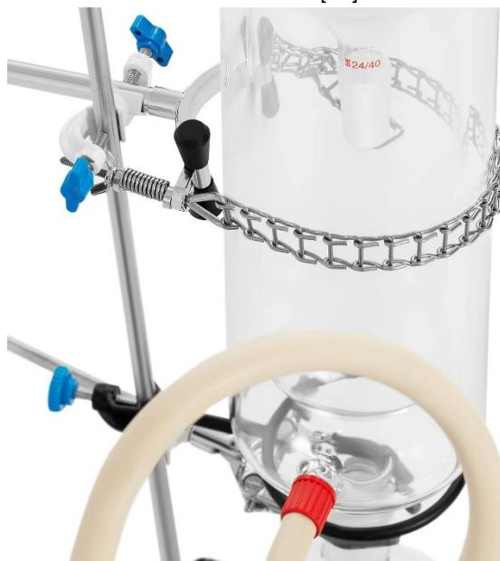
26. Asegurar la conexión entre el congelador [17] y el matraz receptor (1000ml) [20] con un clip.
