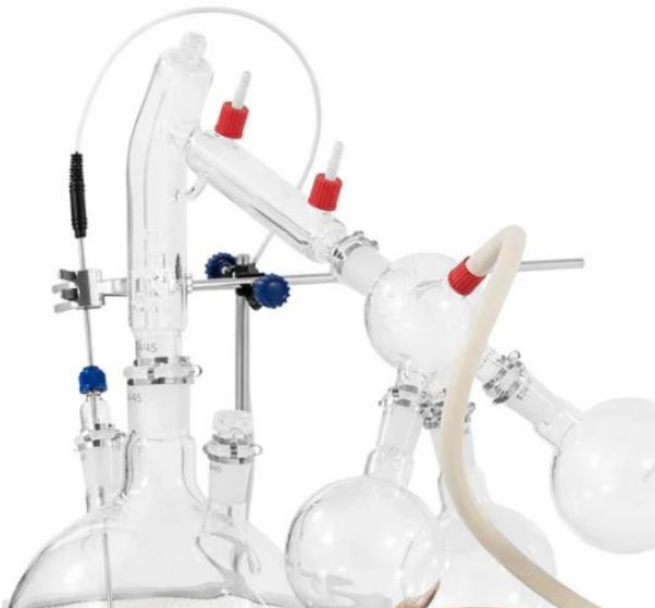
14. Pod nejnižě vysunutou odběrnou baňkou (500 ml) [13] položte stavitelnou podložku [23].
