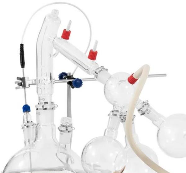
14. Positionnez le support élévateur réglable [23] sous le ballon récepteur le plus bas (500 ml) [13].
