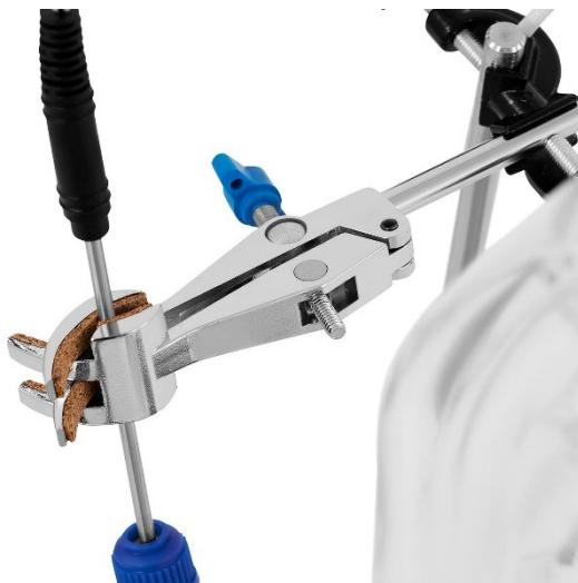
8. Entfernen Sie das interne Thermoelement (falls angeschlossen) aus der Buchse an der Unterseite des Heizmantels.
