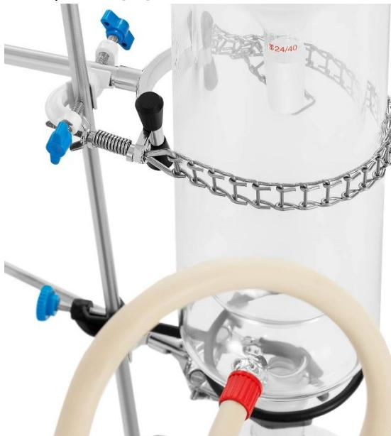
26. Zajistěte spojení chladiče [17] s odběrnou baňkou (1000 ml) [20] klipem.
