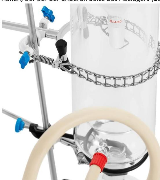
26. Sichern Sie die Verbindung zwischen der Kühlfaile [17] und dem Auffangkolben (1000 ml) [20] mit einer Klammer.
