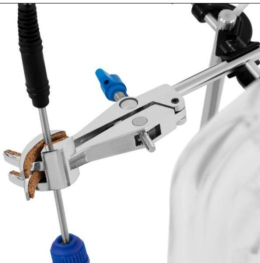
8. Retirez le thermocouple interne (s'il est connecté) de la prise située à la base du chauffe-ballon.
