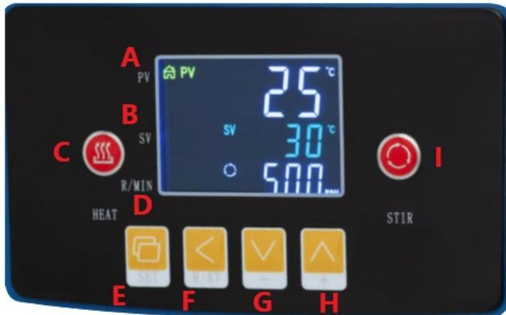
A - PV – změřená (aktuální) hodnota teploty
