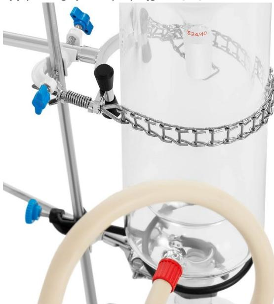
26. Zabezpieczyć połączenie wymrażacza [17] i kolby odbiorczej (1000ml) [20] za pomocą klipsa.
