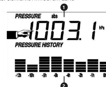
Aby skonfigurować parametry ciśnienia atmosferycznego należy dotknąć panelu odbiornika w obszarze [D]. Po wybraniu odpowiedniej opcji do zmiany przyciski +/- oraz ON/OFF będą migać i możliwa będzie modyfikacja.
