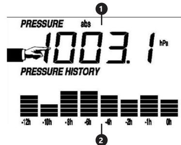
Afin de configurer les paramètres de la pression atmosphérique touchez le panneau du récepteur dans la zone [D]. Après avoir sélectionné l'option appropriée à modifier, les boutons +/- et ON/OFF clignotent et la modification est possible.
