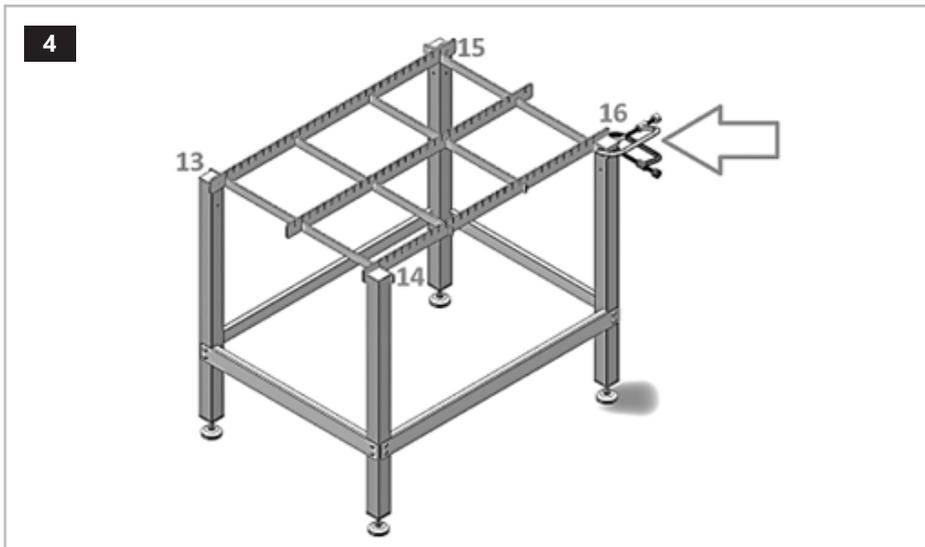
**DE** | Mit beigelegten Schrauben, Unterlegscheiben und Mutter zusammenschrauben (E-P):
