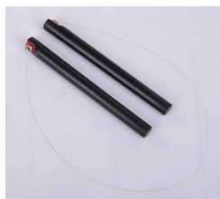
Lanko s držáky pro oddělování obrazovky displeje.
