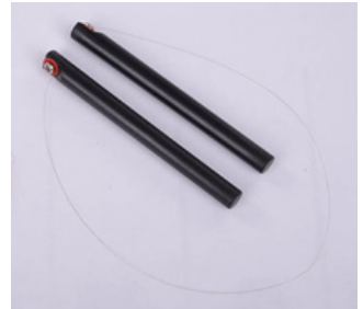
Schneidedraht mit Griffen zum Ablösen des Displays.
