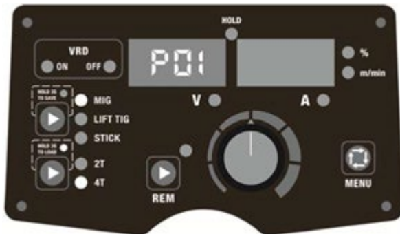
Kuva 16. Parametrien lataus P01:een
