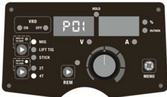
Obr. 16. Načtení parametrů na adrese P01
