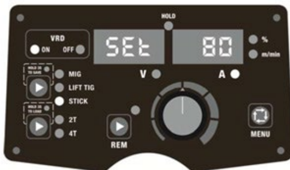
Abb. 1. Die VRD-Funktion ist aktiviert.
