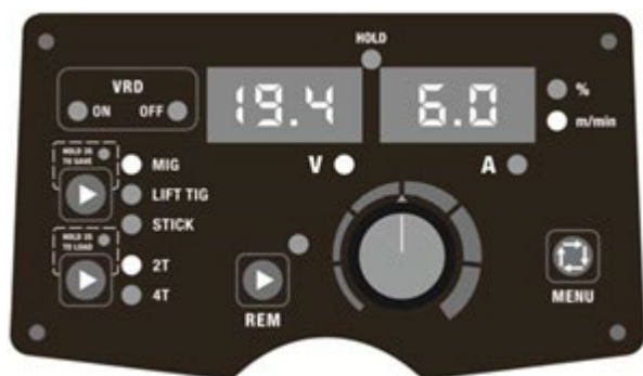
Fig. 7. Vista del panel en modo MIG y parámetros preconfigurados.
