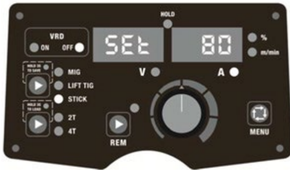
Obr. 2. Funkcia VRD vypnutá.
