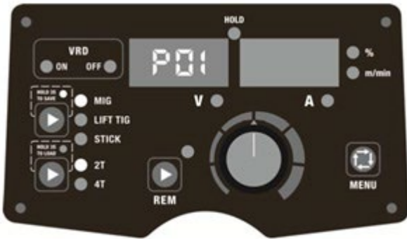
Kuva 15. Parametrien tallentaminen osoitteeseen P01
