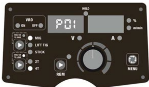
Afb. 16. Parameters laden op P01
