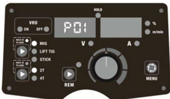
Slika 15. Shranjevanje parametrov na naslovu P01
