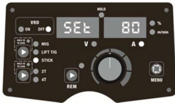
Fig. 2. VRD-funktionen er deaktiveret.
