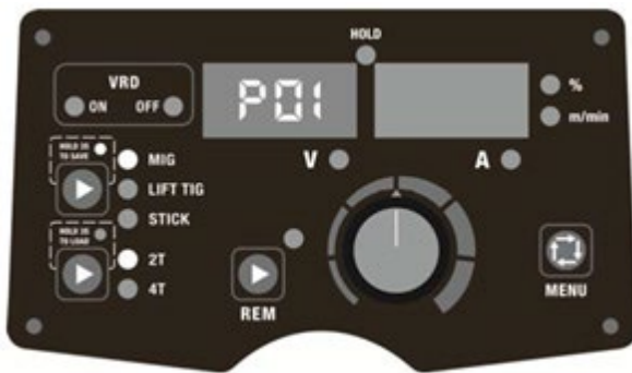
Abb. 15. Speichern von Parametern unter der Adresse P01
