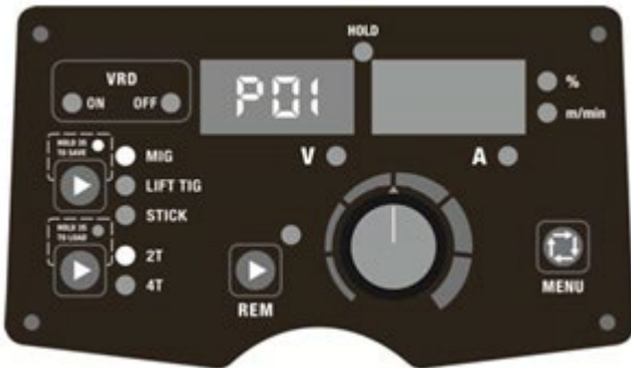
Obr. 15. Uloženie parametrov na adrese P01
