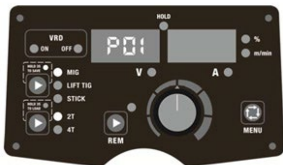
Afb. 15. Parameters opslaan op adres P01
