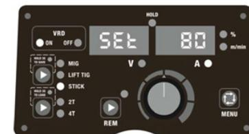
Fig. 1. The VRD function enabled.
