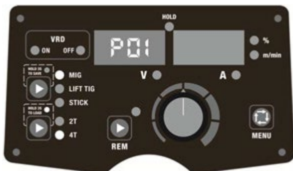
Slika 16. Učitavanje parametara na P01
