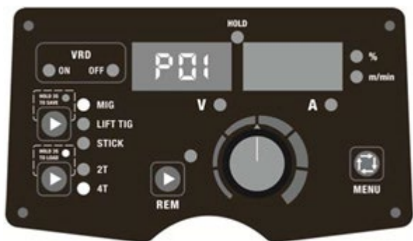
Fig. 16. Încărcarea parametrilor la P01
