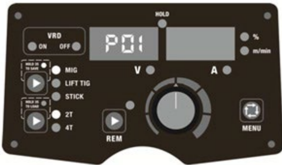
Εικ. 15. Αποθήκευση παραμέτρων στη διεύθυνση P01
