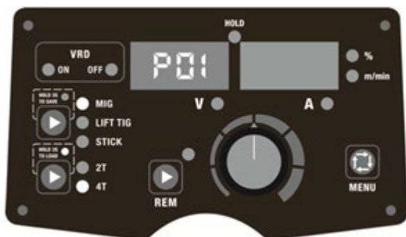
16. ábra. A paraméterek betöltése a P01 címre
