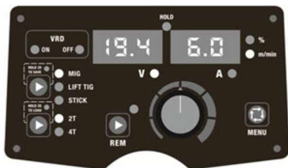
Slika 7. Pogled na ploščo v načinu MIG in prednastavljeni parametri.
