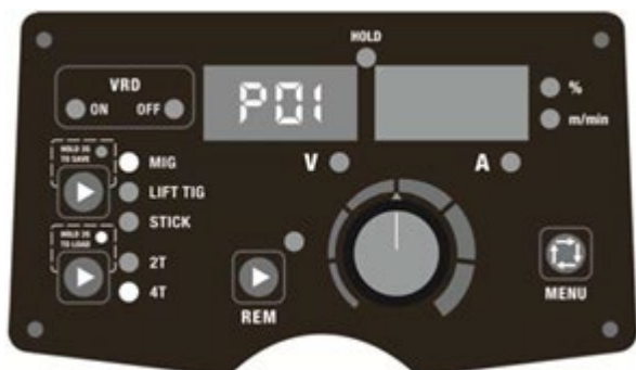
Rys. 16. Ładowanie parametrów pod adresem P01
