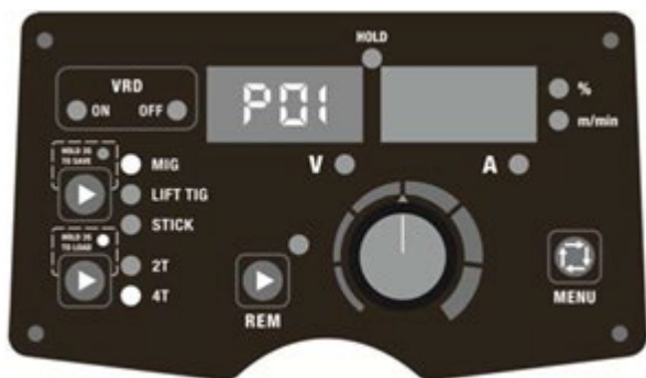
Фиг. 16. Зареждане на параметри на P01
