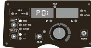
Fig. 15. Sauvegarde des paramètres à l'adresse P01
