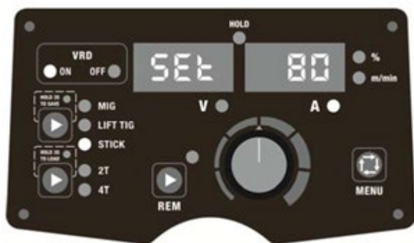
Slika 1. Omogućena VRD funkcija.
