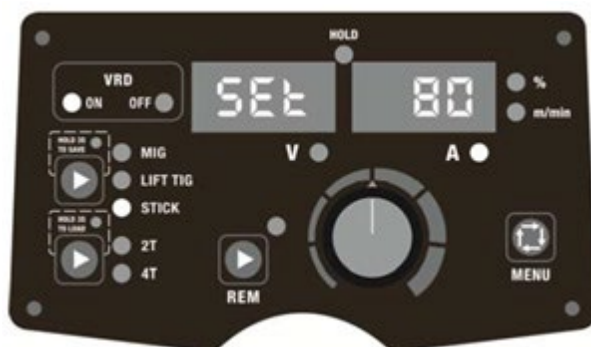
Fig. 1. VRD-funktionen er aktiveret.
