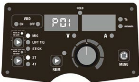
Фиг. 15. Запазване на параметри на адрес P01
