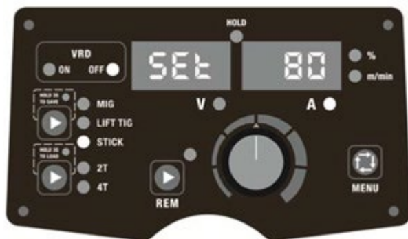
Fig. 2. Funcția VRD dezactivată.
