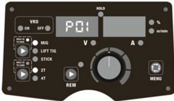
Obr. 15. Uložení parametrů na adrese P01
