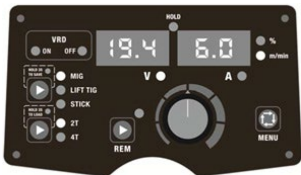
7 pav. Skydelio vaizdas MIG režimu ir iš anksto nustatyti parametrai.
