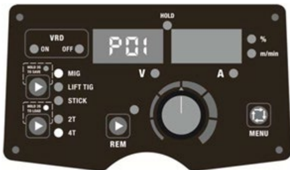
Fig. 16. Carga de parámetros en P01
