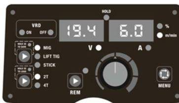
Fig. 7. Panelen i MIG-läge och förinställda parametrar.
