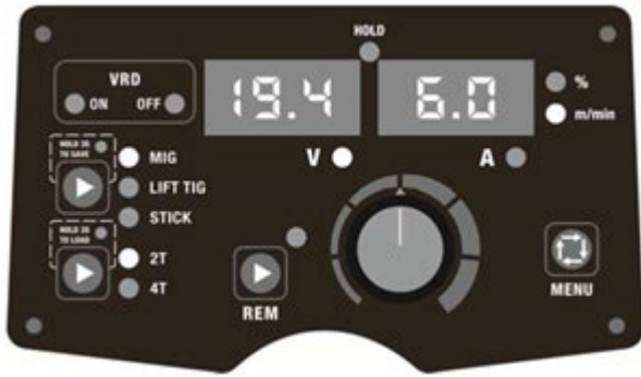
Kuva 7. Paneelin näkymä MIG-tilassa ja esiasetetuilla parametreilla.
