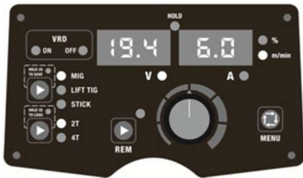
7. ábra. A panel nézete MIG üzemmódban és az előre beállított paraméterek.
