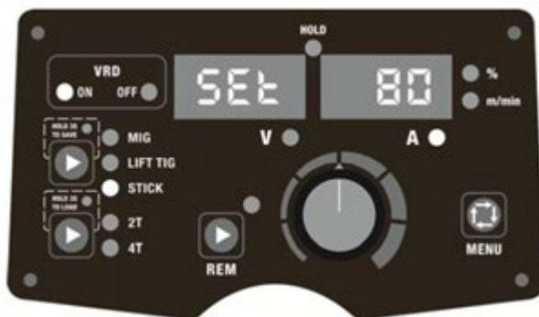
Fig. 1. Função VRD ativada.
