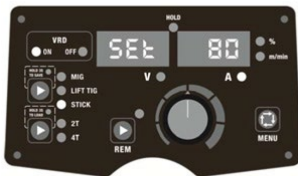
Fig. 1 : Fonction VRD activée.
