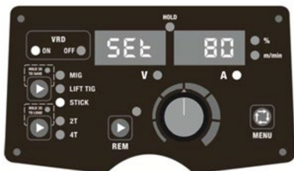
Rys. 1. Funkcja VRD włączona.
