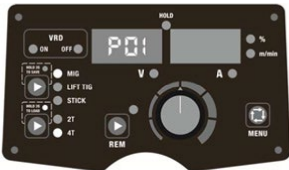
Fig. 16. Indlæsning af parametre på P01
