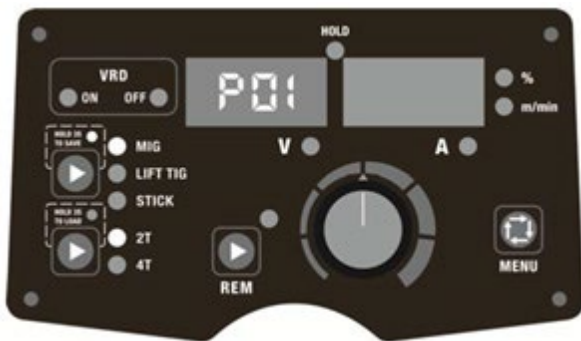
Fig. 15. Lagre parametere på adressen P01
