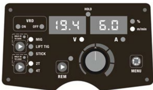
Rys. 7. Widok panelu w trybie MIG i wstępnie ustawione parametry.
