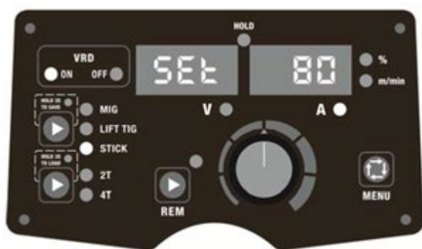
Fig. 1. Funcția VRD activată.
