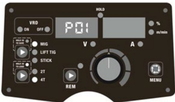
Εικ. 16. Φόρτωση παραμέτρων στο P01
