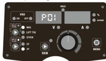
Abb. 16. Herunterladen der Parameter unter der Adresse P01
