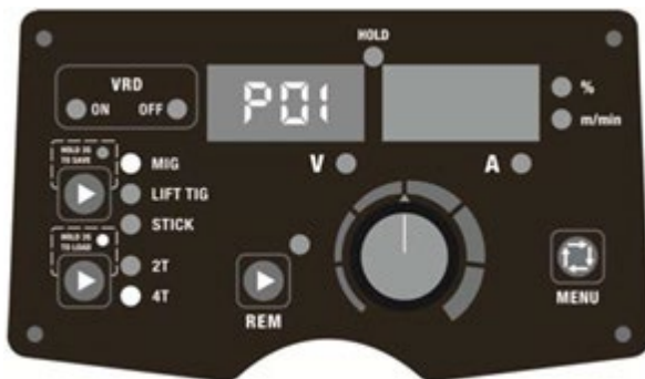
16 pav. Parametrų įkėlimas ties P01
