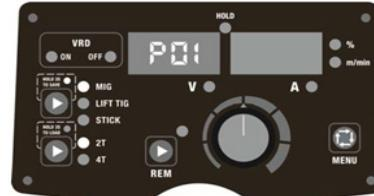
Abb. 15. Speicherung der Parameter unter der Adresse P01
