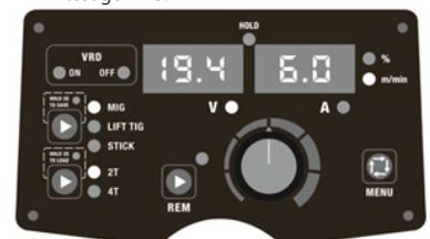
Fig. 7. Vista del panel en modo MIG y de los parámetros previamente establecidos.
