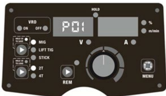
Slika 15. Spremanje parametara na adresi P01
