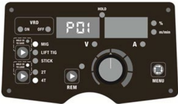
Fig. 16. Loading parameters at P01
