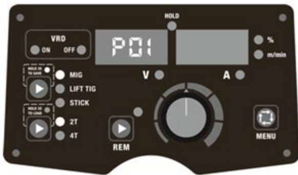
15 pav. Parametrų išsaugojimas adresu P01
