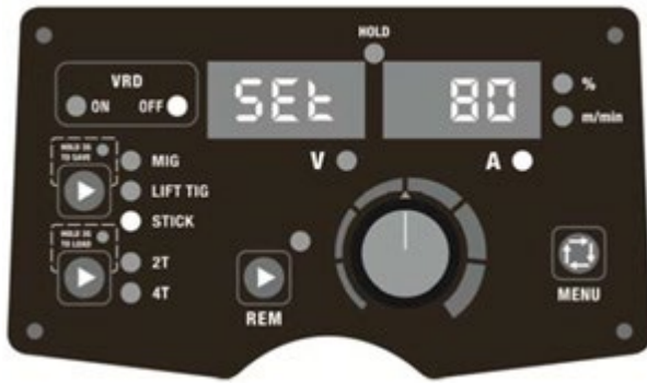
Fig. 2 : Fonction VRD désactivée.
