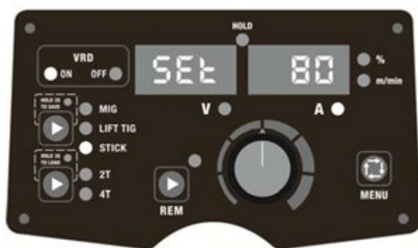
Fig. 1. Función VRD activada.
