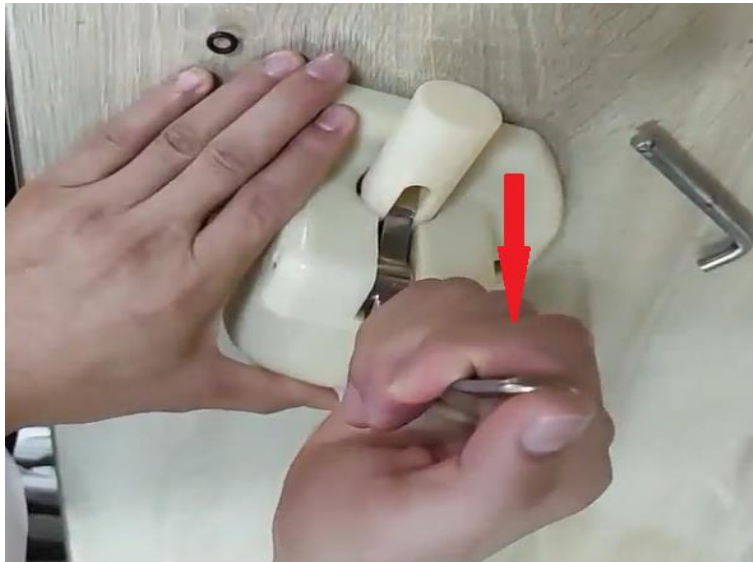
3. Hebel nach unten ziehen und entfernen
