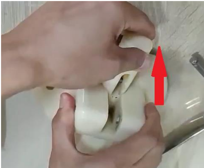
4. Kolben zur Reinigung nach oben ziehen
