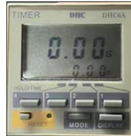
Dans un réglage donné, les plus importants sont les boutons „4, 3, 2, 1 „ qui vous permettent de régler le temps exact d'un cycle de remplissage dans la plage de 00,00 à 99,99 secondes - chaque bouton est subordonné à un chiffre donné, et chaque fois que vous appuyez dessus, sa valeur change dans la plage de 0 à 9. Après chaque cycle, l'appareil s'arrête automatiquement et passe en mode veille.
