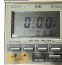
In una determinata impostazione, i più importanti sono i pulsanti „4, 3, 2, 1 „ che consentono di impostare l'ora esatta di un ciclo di riempimento nell'intervallo 00.00-99.99 secondi - ogni pulsante è subordinato a una data cifra , e ogni volta che viene premuto, il suo valore cambia nell'intervallo 0-9. Dopo ogni ciclo, il dispositivo si arresta automaticamente ed entra in modalità standby.
