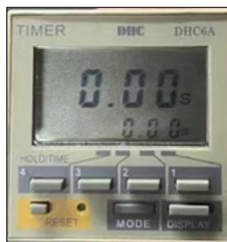
V daném nastavení jsou nejdůležitější tlačítka „ 4, 3, 2, 1 „, která umožňují nastavit přesný čas jednoho cyklu plnění z rozsahu 00,00-99,99 sekund - každé tlačítko je podřízeno dané číslici a při každém jeho stisknutí se jeho hodnota změní v rozsahu 0-9. Po každém cyklu se zařízení automaticky zastaví a přejde do pohotovostního režimu. Ostatní tlačítka nejsou podporována.
