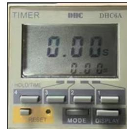
W danym ustawieniu najistotniejsze są przyciski „4, 3, 2, 1”, które pozwalają ustawić dokładny czas jednego cyklu napełniania z zakresu 00,00-99,99 sekund – każdy z przycisków podporządkowany jest danej cyfrce i każdorazowe jego naciśnięcie powoduje zmianę jej wartości w zakresie 0-9. Po każdorazowym cyklu urządzenie samoczynnie zatrzymuje się przełączając w tryb czuwania. Pozostałe przyciski nieobsługiwane.
