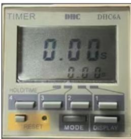
In einer gegebenen Einstellung sind die Tasten „4, 3, 2, 1“ am wichtigsten, mit denen Sie die genaue Zeit eines Füllzyklus im Bereich von 00,00-99,99 Sekunden einstellen können - jede Taste ist einer bestimmten Ziffer untergeordnet, und jedes Mal, wenn sie gedrückt wird, ändert sich ihr Wert im Bereich von 0-9. Nach jedem Zyklus schaltet das Gerät automatisch ab und geht in den Standby-Modus.
